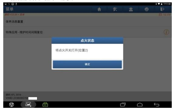
6. 确认车载电压在 12.5V 以上,点击"确定";
