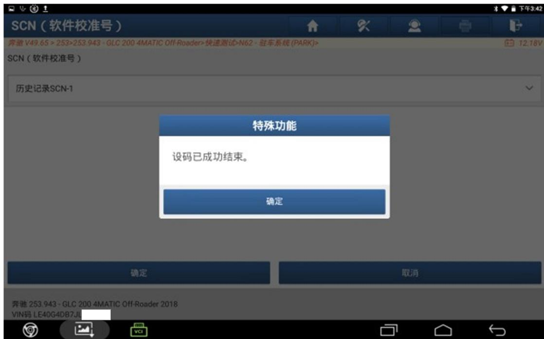
6. 关闭点火开关，点击“确定”
