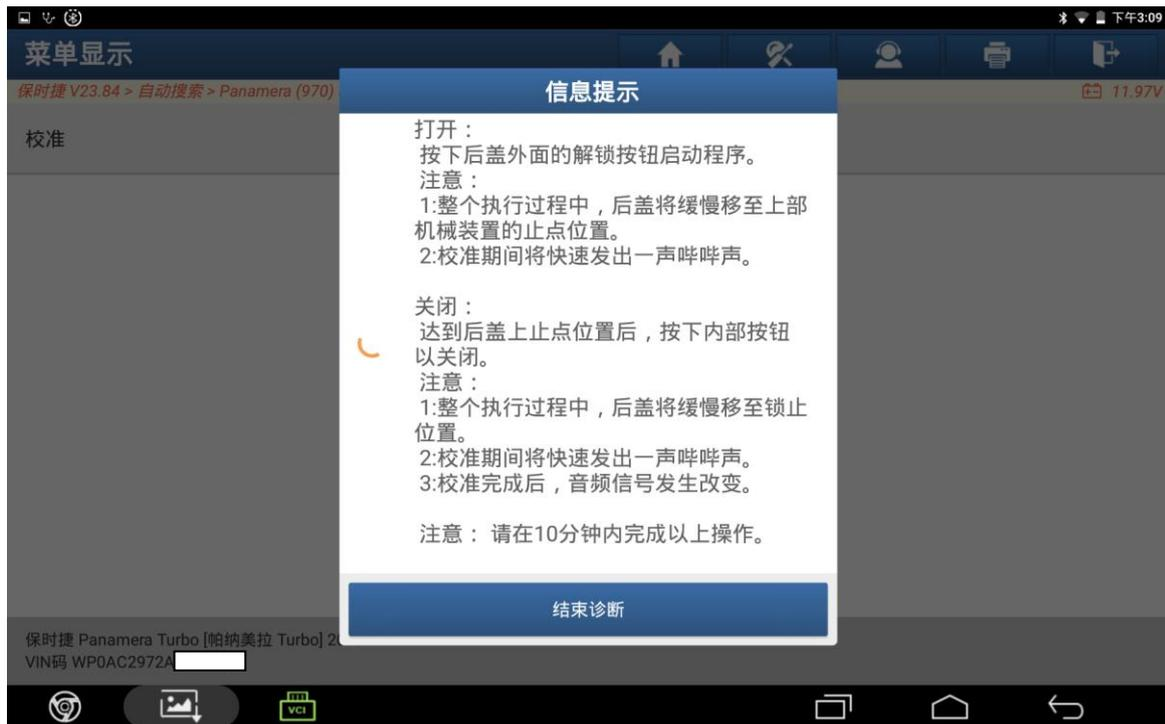
7. 按下尾盖的开锁按钮，等到尾盖完全上升到最上部时可以听到哔哔声，再按下尾盖的关闭按钮，等到尾盖完全下降到最下部时可以听到哔哔声。
