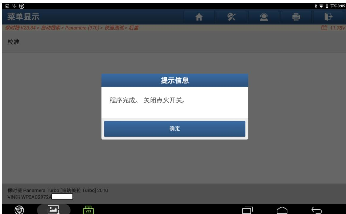
8. 点击确定完成操作。再次读取故障码显示无故障码。
