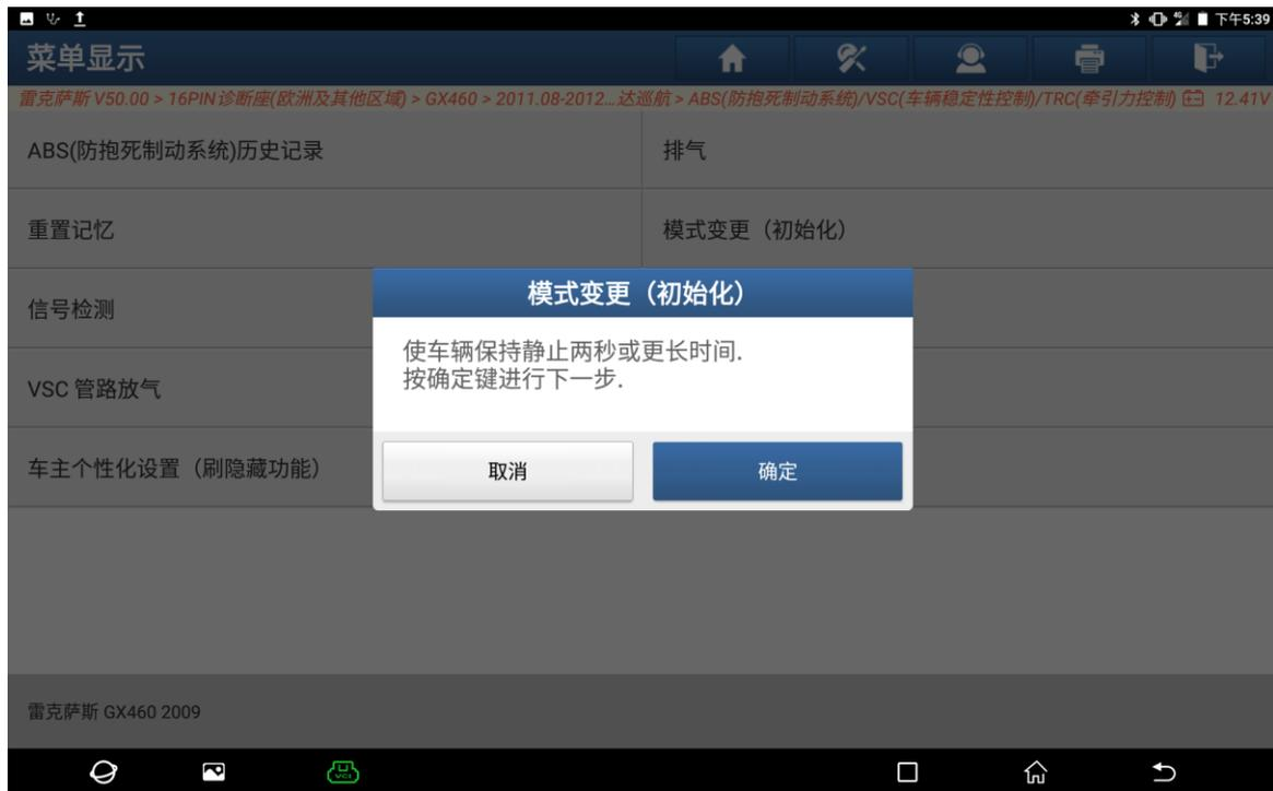
6. 当 ABS&VAC 灯闪亮时，校准完成。请确保在退出本功能前按下坡道辅助按钮直至仪表盘中坡道辅助指示灯闪烁。
