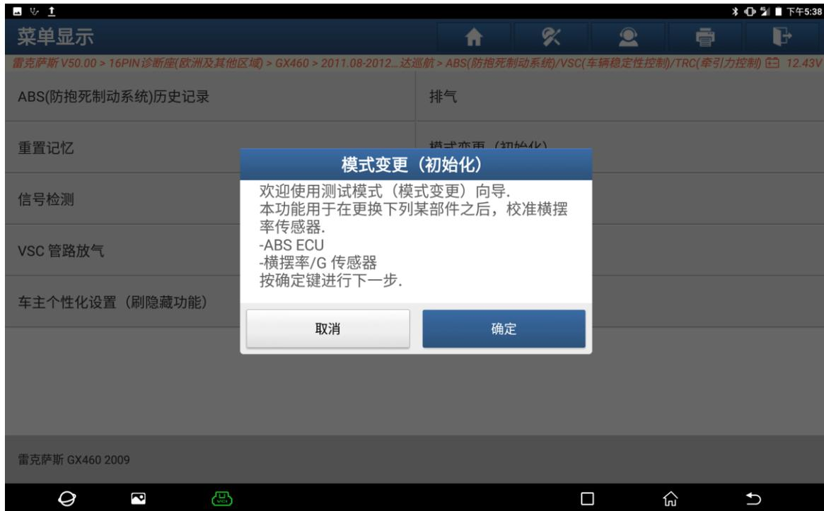
4. 确认下列条件: 车辆位于平坦地面上, 方向盘处于正前位置, 换挡杆位于驻车位置, 发动机未运转, 点火开关位于 ON, 点击“确定” (如下图)。
