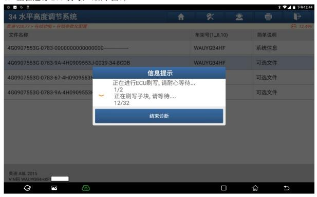
9. 关闭点火30秒,再重新打开点火开关,点"确定",(如下图);
