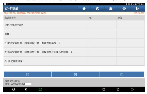
5. 已选择功能激活安装位置。拉起驻车制动按钮并等待3秒左右。踩下刹车踏板并按下驻车制动按钮并保持3秒。点击"确定"(如下图)
