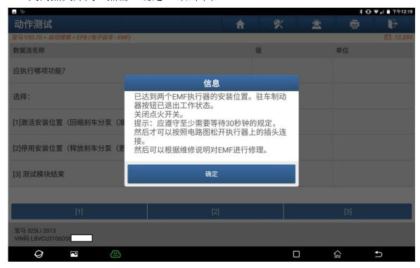
11. 已选择功能禁用安装位置,在下一步骤中将重新激活驻车制动器按钮。 点击"确定"(如下图)
