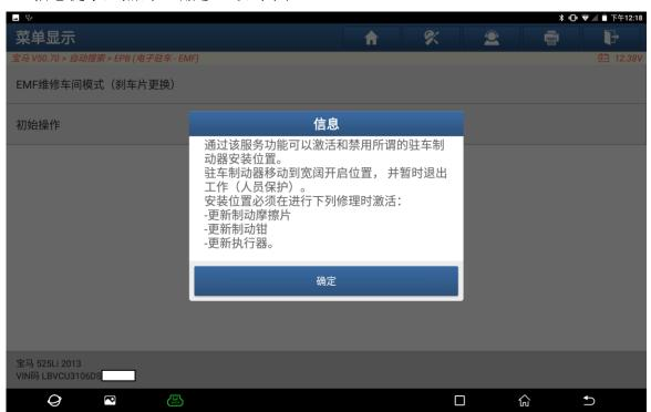
4. 点击"1"激活安装位置(回缩刹车分泵(准备换刹车片))(如下图)
