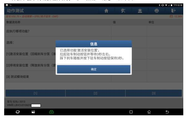
6. 下一步通过诊断检查制动器的两个 EMF 执行器是否都松开了。点击"确定"(如下图)
