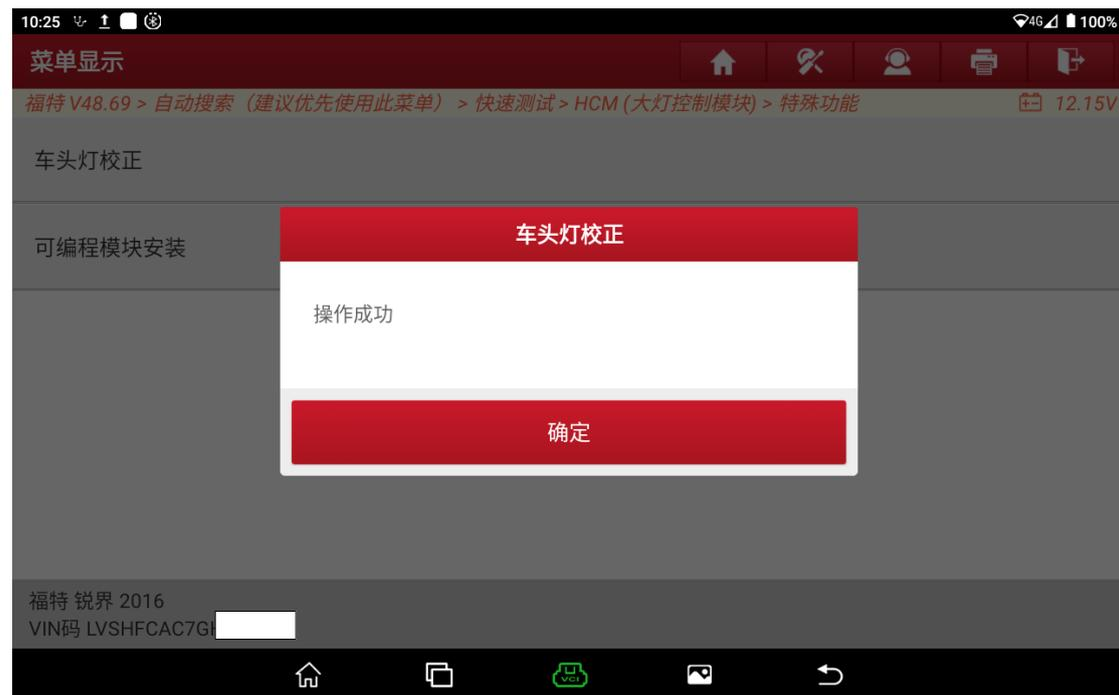
11. 提示“关闭点火开关”，关闭后点“确定”，校准结束（如下图）；
