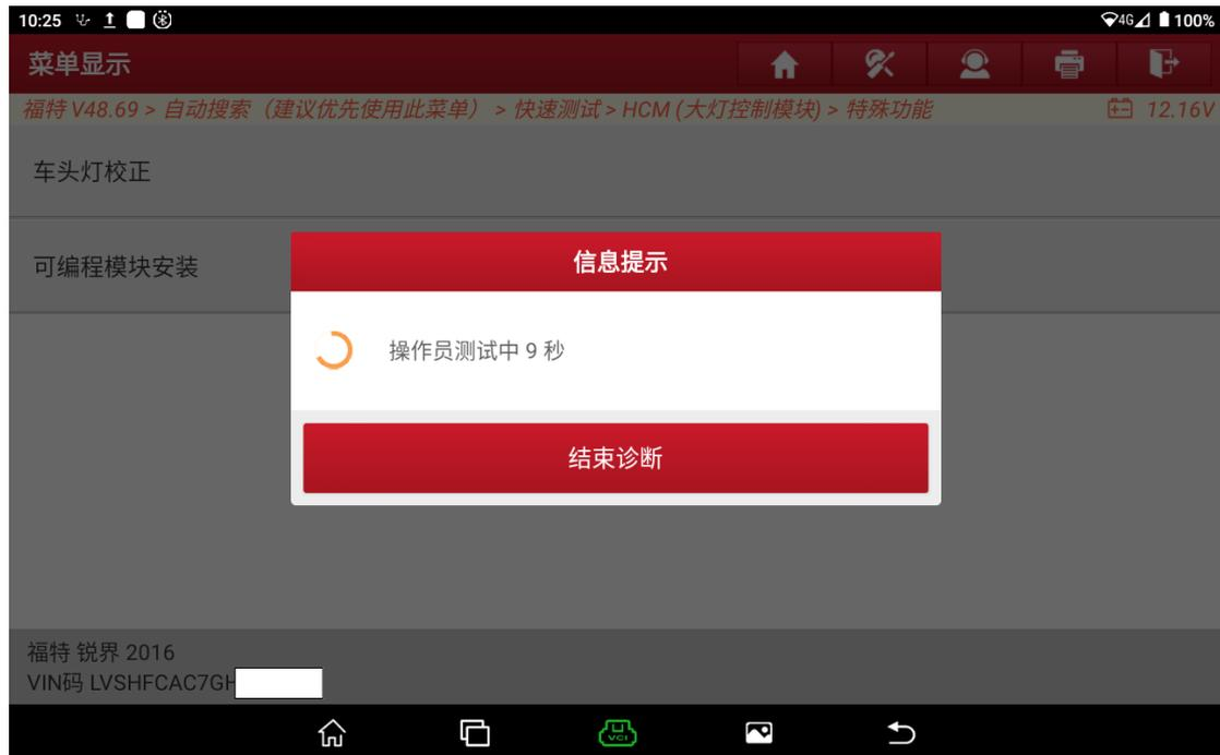
9. 点“确定”执行大灯机械校准，可看到大灯自行校准（如下图）；
