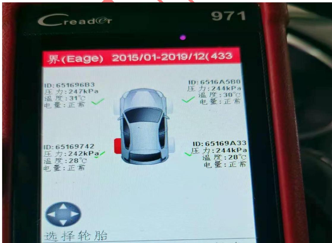
12. 四个传感器激活后，回到诊断设备，在点“确定”（如下图）；
