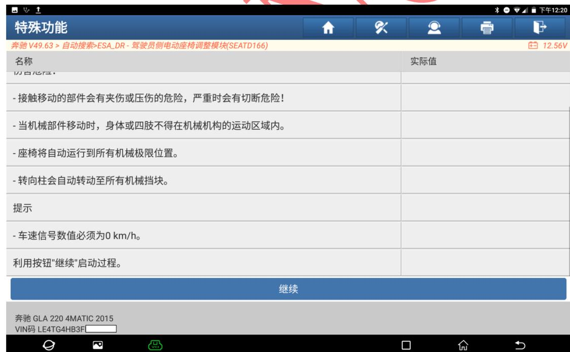
8. 提示“正在进行标准化,请稍后”,自动执行标准化学习过程中座椅会前后移动,小心夹伤(如下图);
