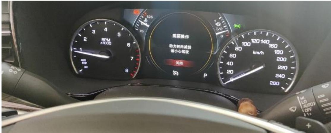
用 X431PADV 读出电动助力转向系统有两个故障码，方向机助力模块损坏，需更换方向机总成。
