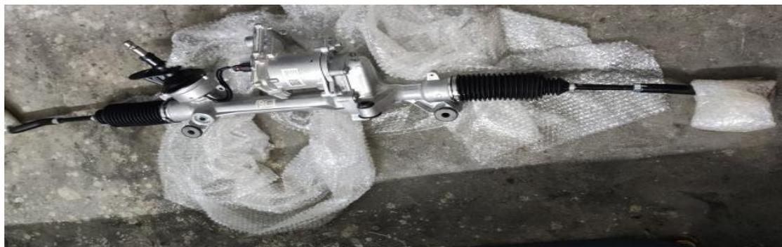
装上全新的方向机总成后，需对方向助力模块进行编程
