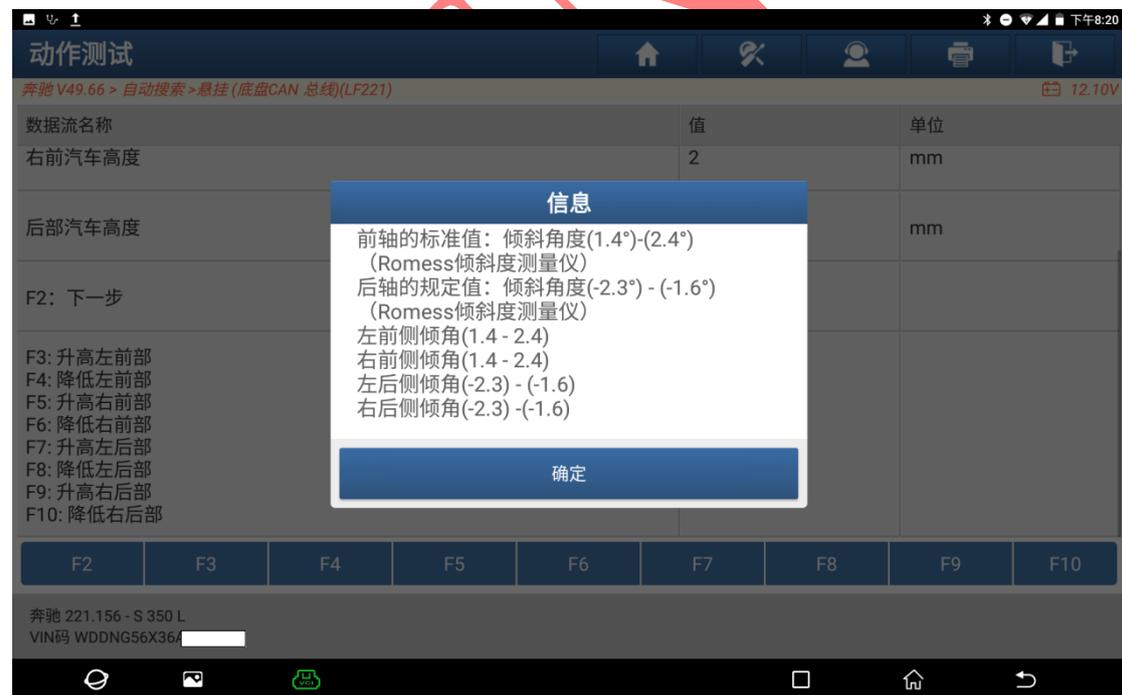
8. 按照提示，依次输入之前步骤提示的四条减震的标准值，选取最低标准值输入，输入后点“确定”（如下图）；
