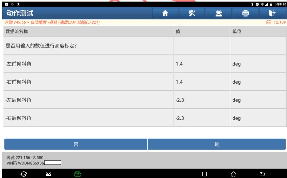
10. 提示“高度标定成功”，点“确定”，然后出去路试，回来后检查高度是否一致，高度一致，标定完成，高度不一致，重复执行该功能（如下图）。
