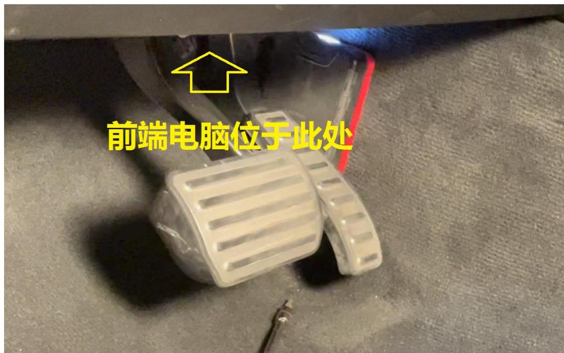
图 1-1-1 前端电控模块位置
