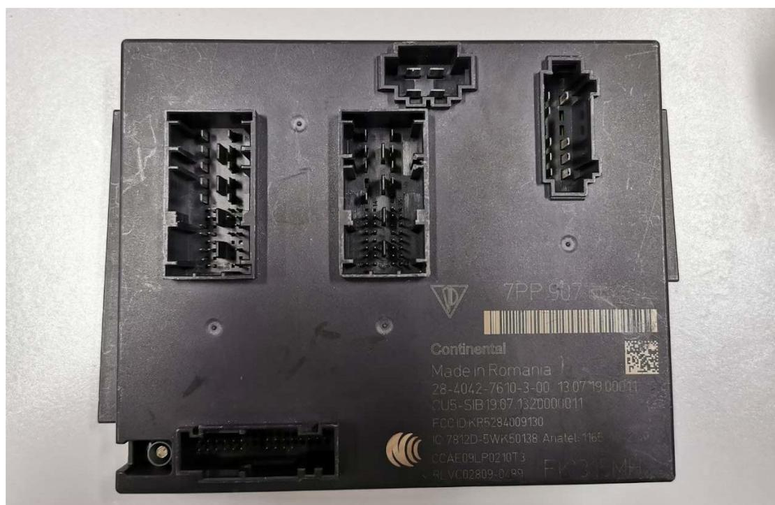
图 1-2-2 前端电控模块外观
