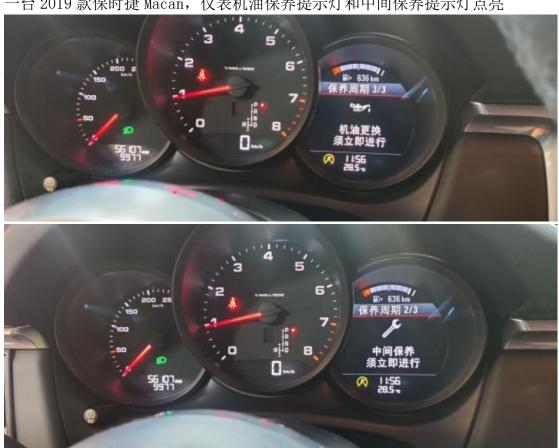
保养完成后,用 431PADIII 进行保养复位(注意:设备需连接网络,点击诊断)
