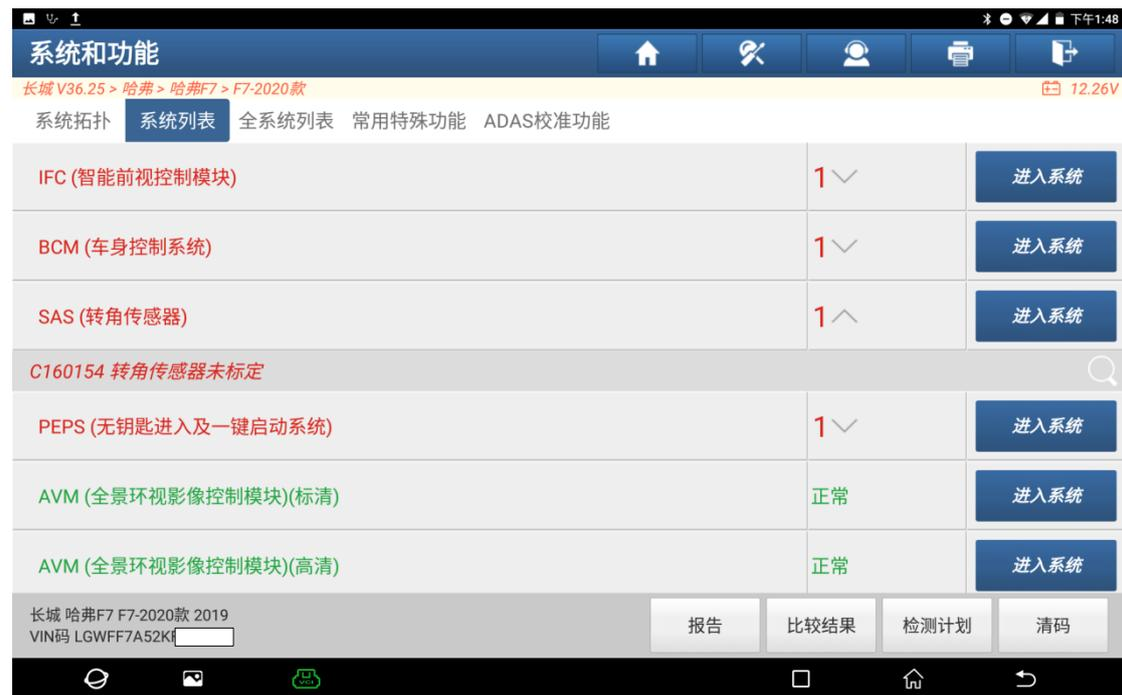
7. 进入后读取到故障码“转角传感器未标定”(如下图);
