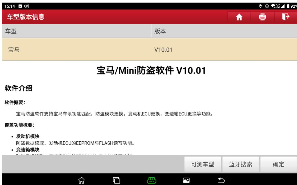
4. 此功能需把发动机 ECU 拆下，在平台上进行操作，不需要接车的 OBD 头连接好编程器后，点击确认。如下图
