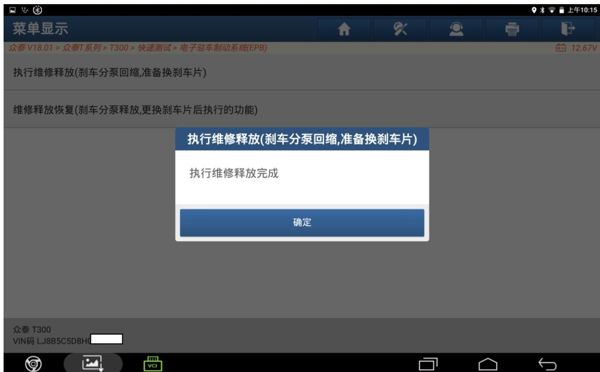
6. 点击【维修释放恢复（刹车分泵释放，更换刹车片后执行的功能）】。
