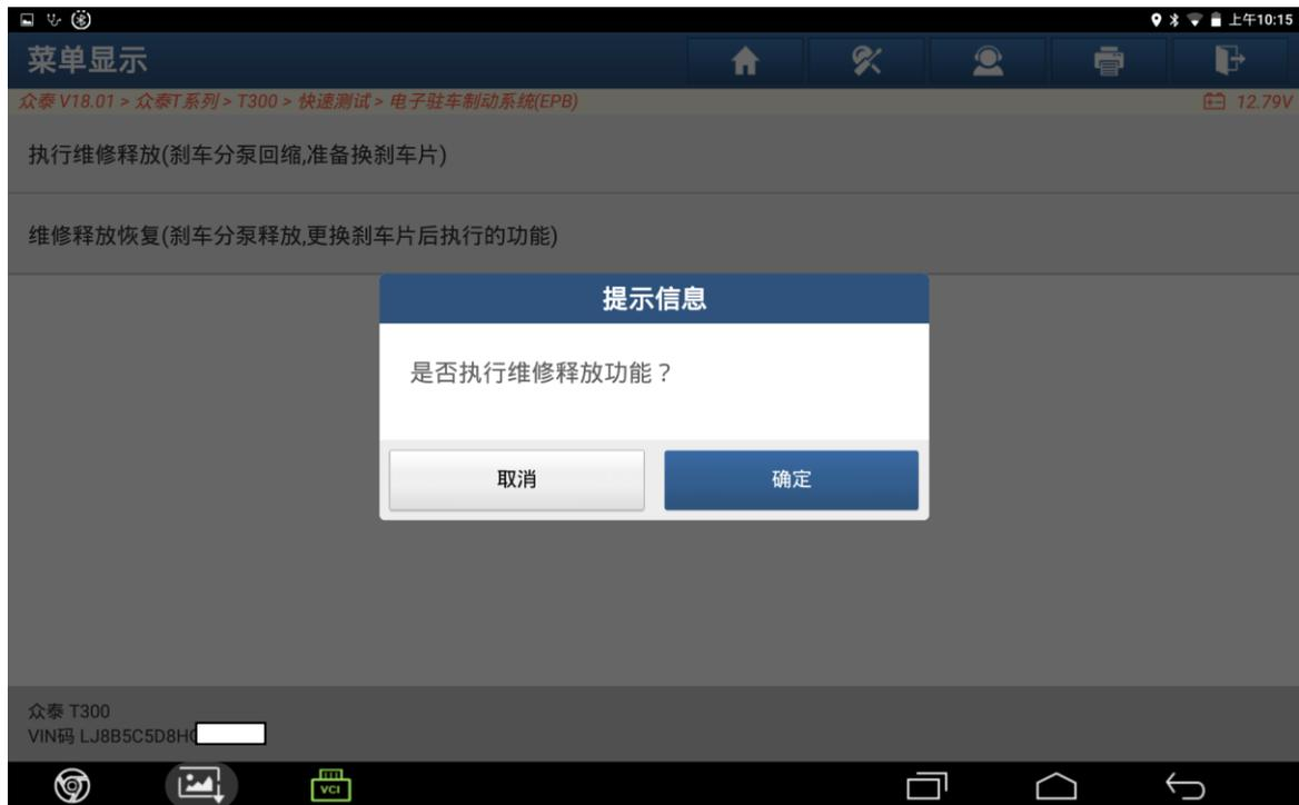
5. 点击“确定”完成释放操作，此时可以拆下旧的后制动片后再装上新的后制动片。
