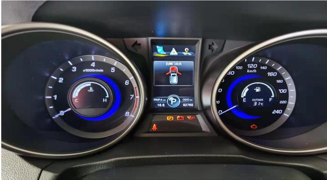
13. 维修完成后，执行【维护关闭（刹车分泵释放，更换刹车片后执行的功能）】（如下图）；
