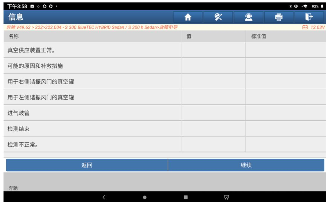
此故障码的检测完成，可能的原因如上图，根据提示进行维修。点“继续”完成此故障码的检测。
