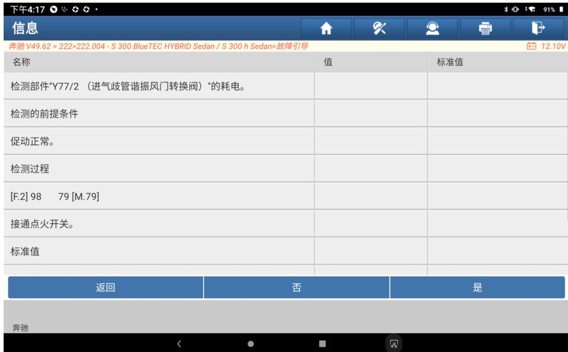
根据上一步插线图连接 检测相关部件，与标准值进行比较（如下图）。
