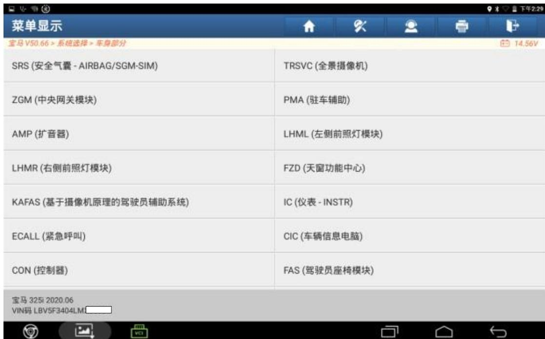
7. 读取故障码为【930BD7 右侧压力传感器(压力软管系统)对正极短路或断路】，故障码状态为【永久】故障码无法清除，根据故障码初步判断为行人保护压力传感器线束损坏或压力传感器故障。
