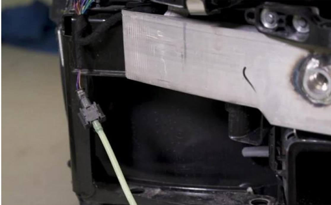
9. 图为传感器和软管安装位置，安装在行人缓冲泡沫内侧
