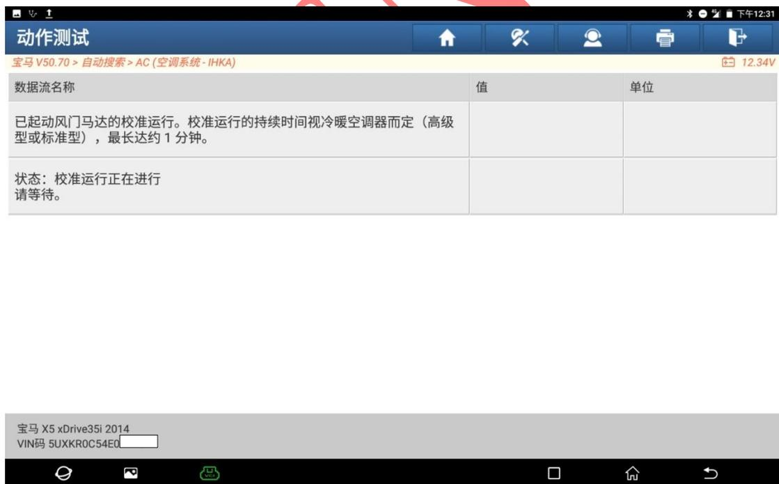
8. 校准成功后提示“风门马达校准成功运行”，点“确定”结束校准（如下图）。
