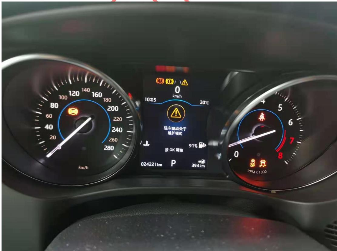
12. 维修完成后，执行【更换驻车制动片-退出维护模式】（如下图）；
