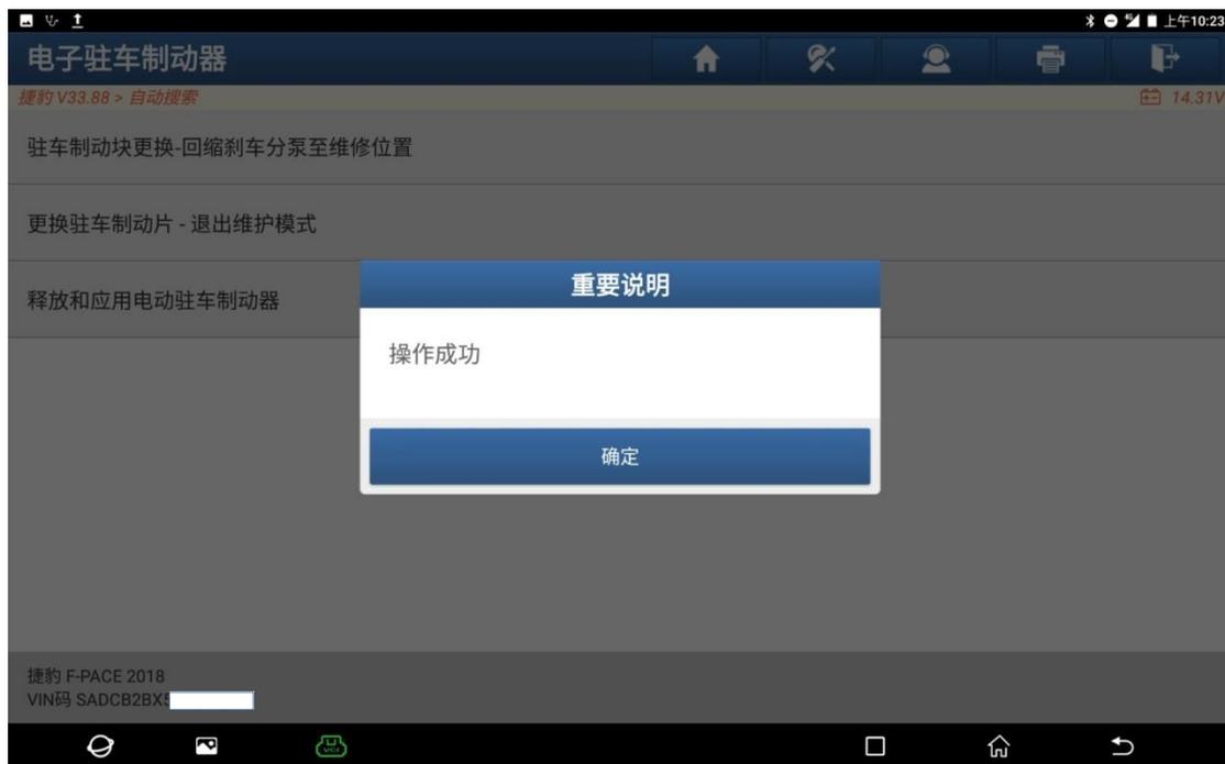
11. 查看仪表，提示“电子驻车制动处于维修模式”，这时候可以执行更换或者维护操作（如下图）；
