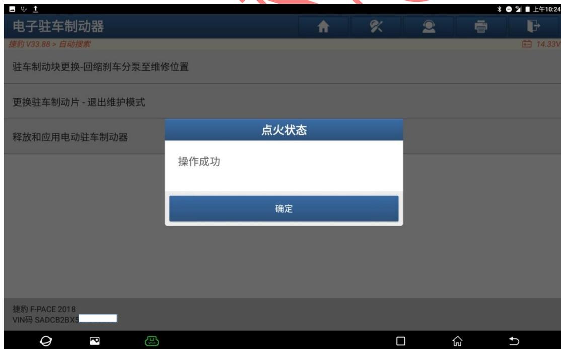
18. 查看仪表，不在提示“电子驻车制动处于维修模式”，电子手刹可以正常使用，功能执行完成（如下图）。
