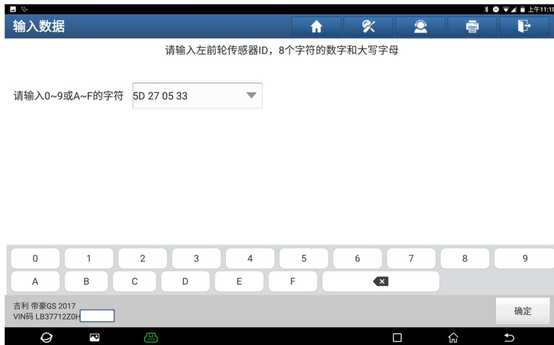
13、依照提示输入四个轮的胎压传感器 ID，输入最后一个轮胎的传感器后，点“确定”就可以进行匹配（如下图）；
