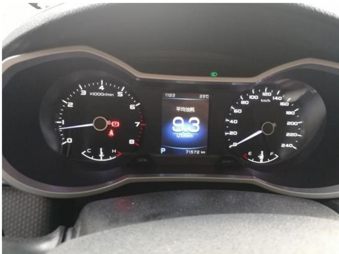
15、重新读取故障码，提示“无故障码”，车辆恢复正常（如下图）。
