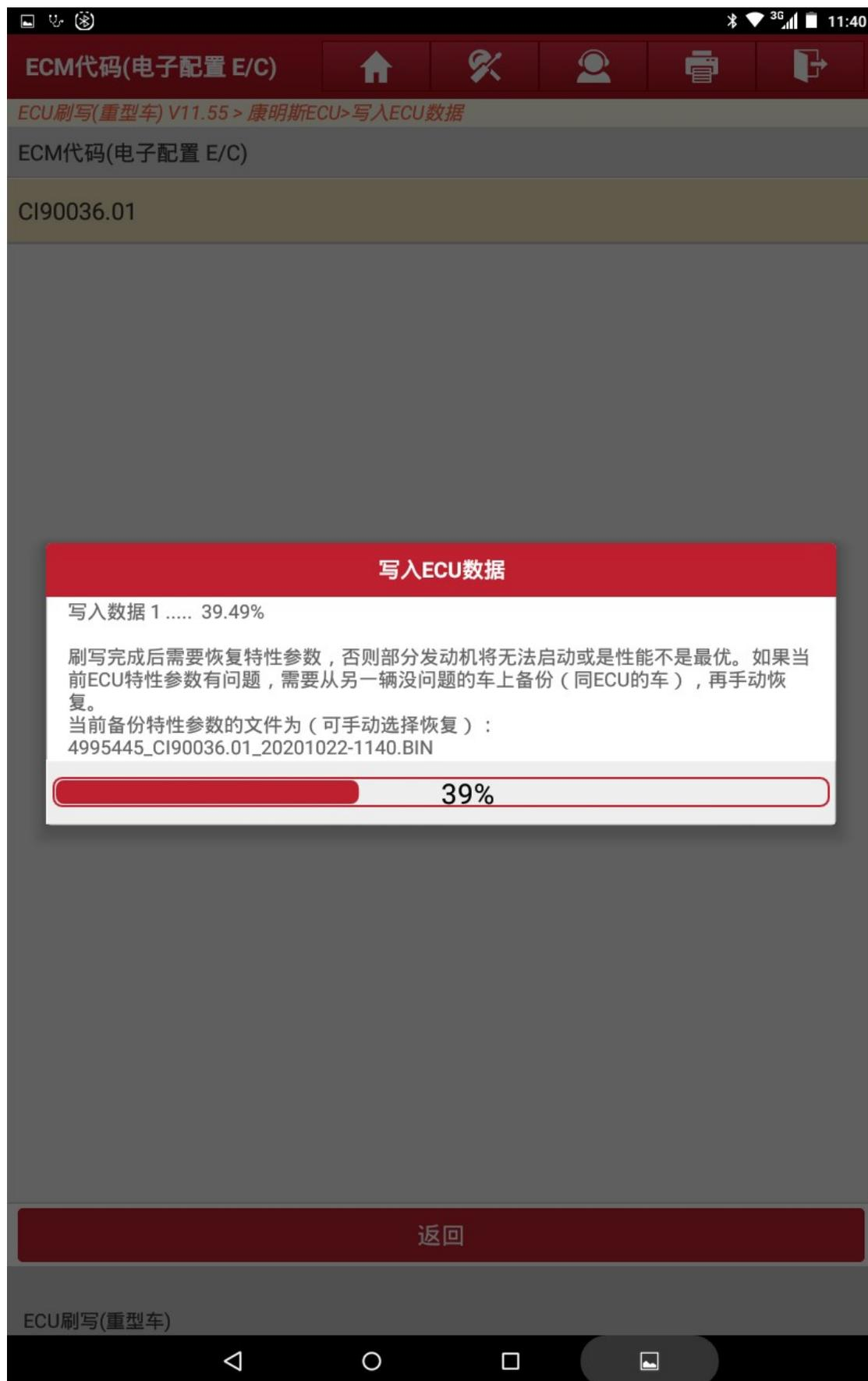
9). 等到提示“刷写数据完成”的菜单时关闭点火开关之后等待 20 秒再打开点火开关再点击确定;
