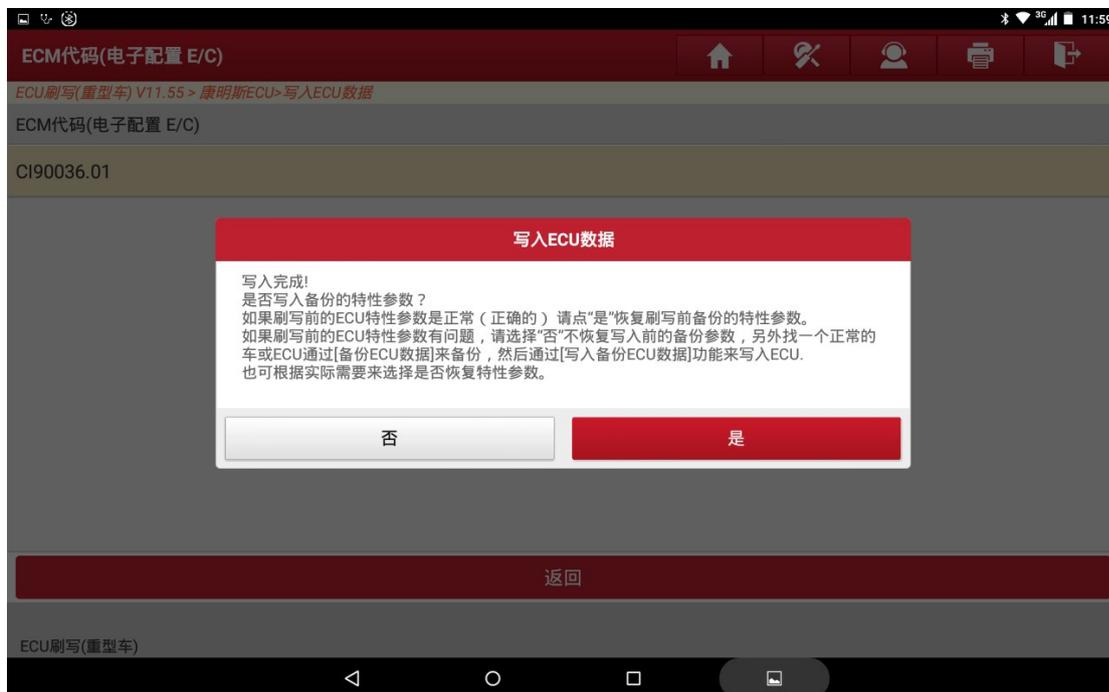
11) . 等到提示“写入 ECU 参数成功”时关闭点火开关之后等待 20 秒之后再打开点火开关之后点击确定完成操作。
