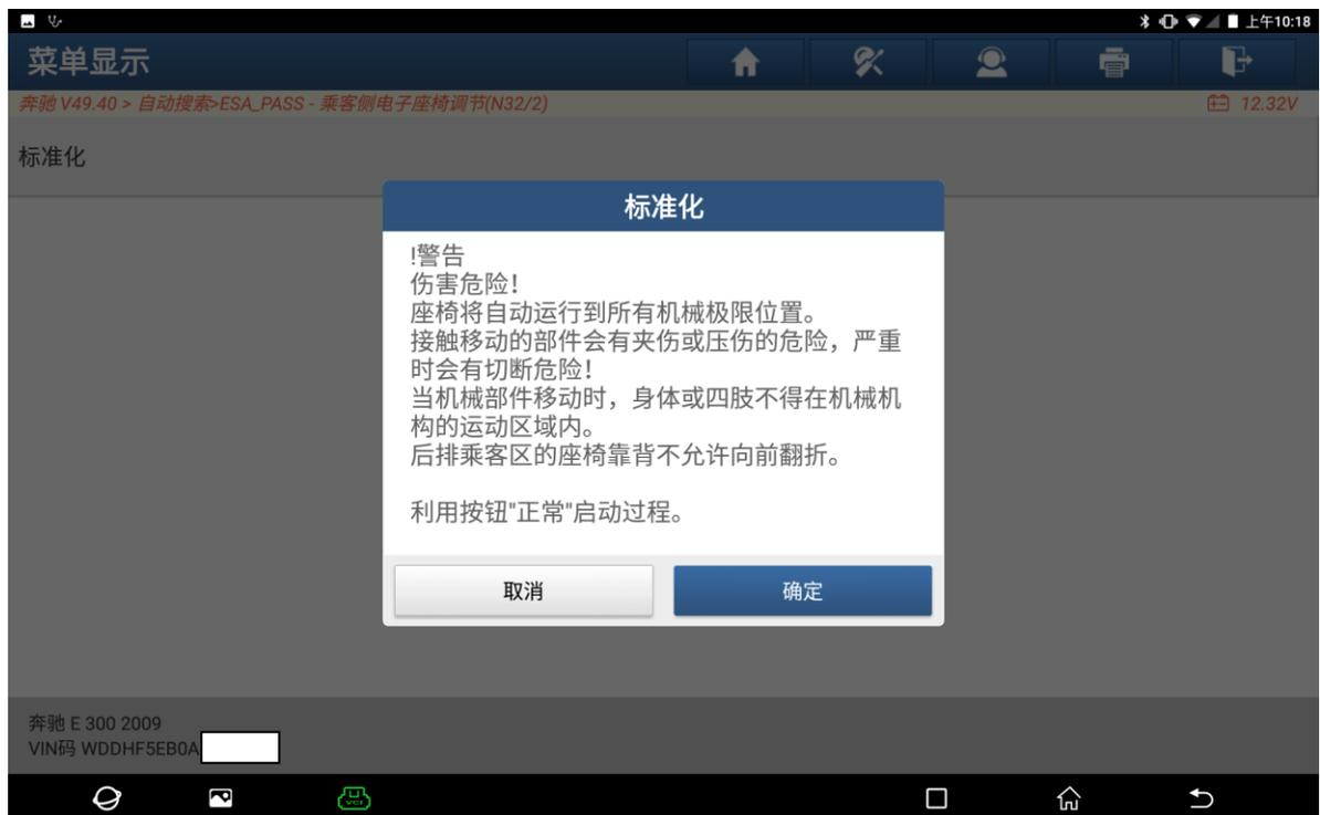
8、提示“正在进行标准化，请稍后”，自动执行标准化学习，同时座椅才移动小心夹伤（如下图）；
