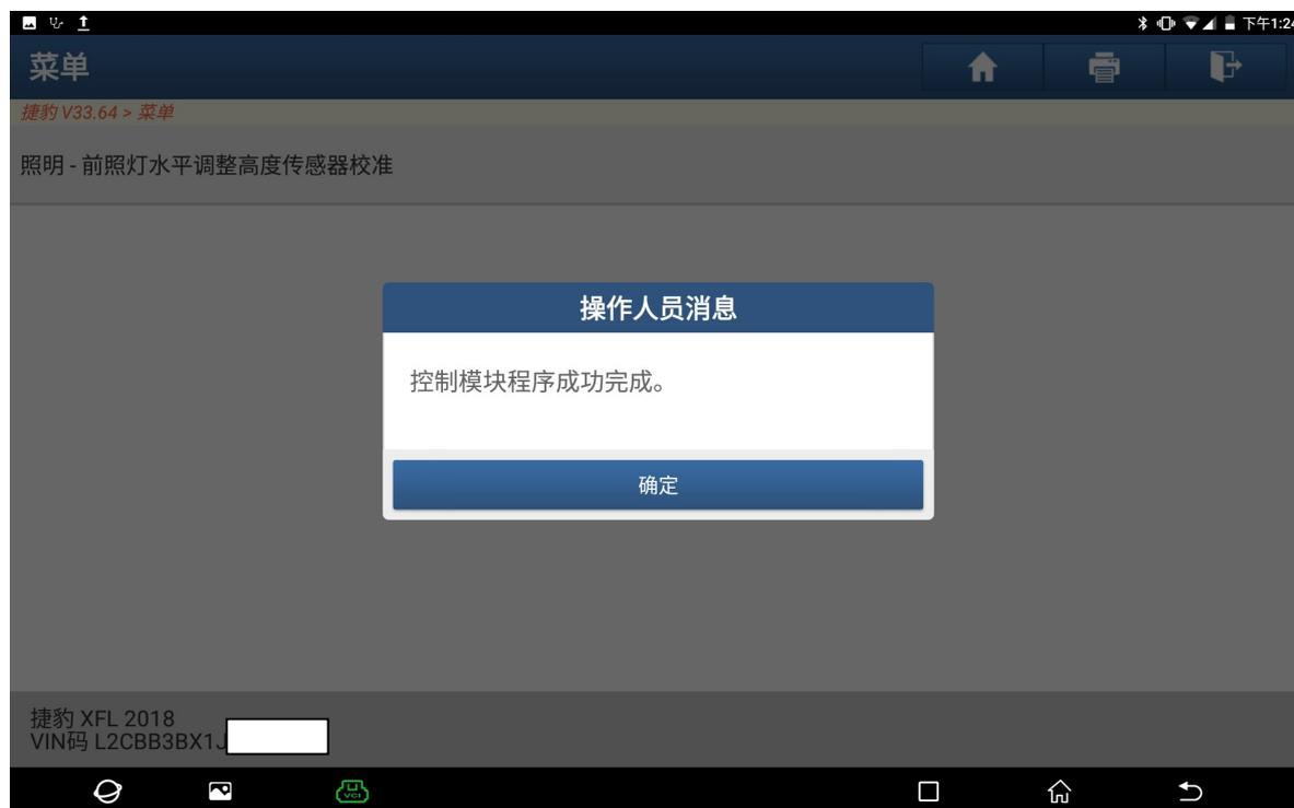
17、 将点火开关关闭，然后点“确定”，校准结束（如下图）。
