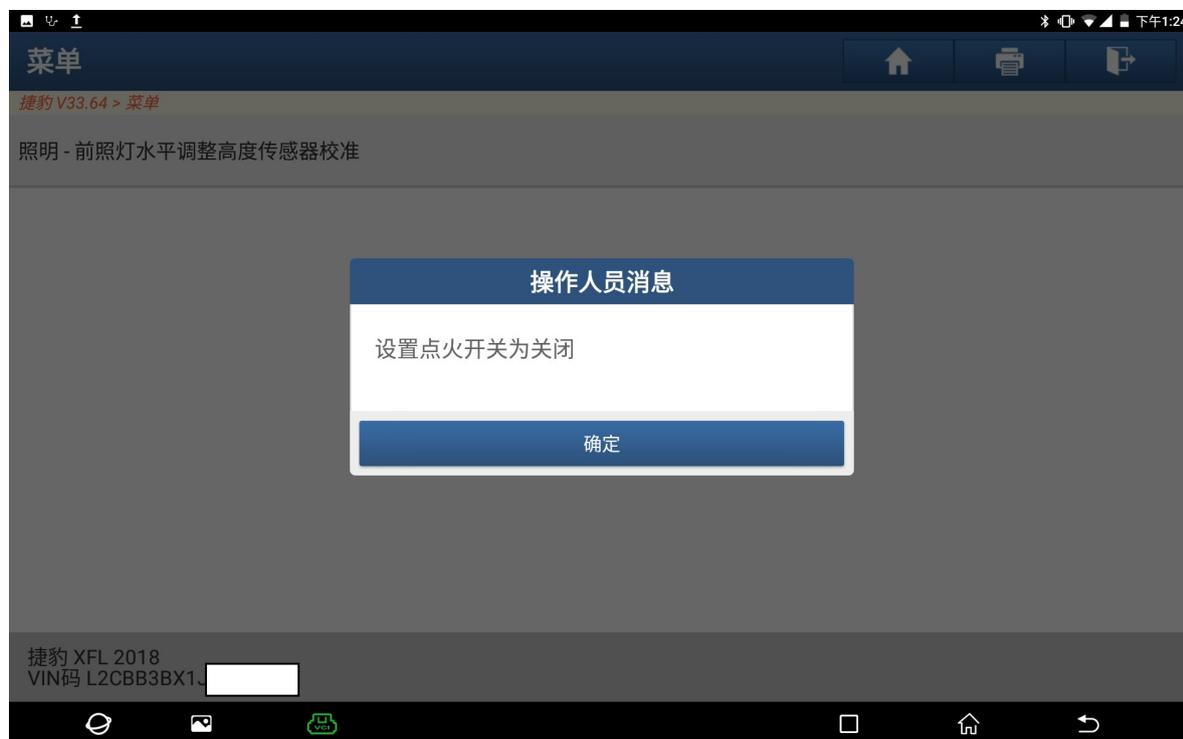
15、 将点火开关打开，然后点“确定”（如下图）；
