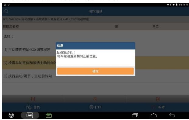
17). 按照提示左右缓慢转动方向盘,方向盘在正中位置 PADIII 显示转向角度值正负误差不大于 1 度,点击下一步
