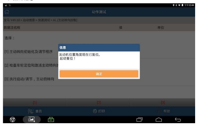
14). 按照提示启动发动机,方向往左缓慢打到底保持两秒,再往右缓慢打到底保持两秒, 重复两个步骤两次后回正方向,仪表板上的 AL 灯还有四驱灯,方向灯熄灭,主动转 向初始化/调节成功,点击确定
