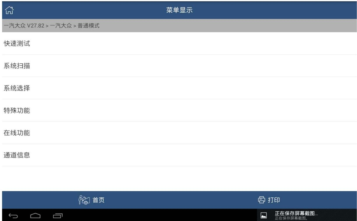
3). 接着选择【在线功能】，在线编码需要连接网络并登录才能执行，如下，输入设备的用户名和密码后完成登录；
