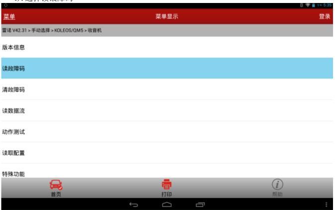
5). 下图所示的故障码表示收音机被锁定,需要解锁收音机,只需进入多媒体接口系统做特殊功能"车辆标识符"。
