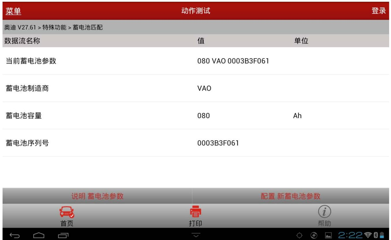
5). 读取成功后选择【配置新蓄电池参数】，依次配置蓄电池制造商、蓄电池容量、以及蓄电池序列号，这里选择蓄电池制造商 VA0，容量 80Ah，序列号 0003B3F053；
