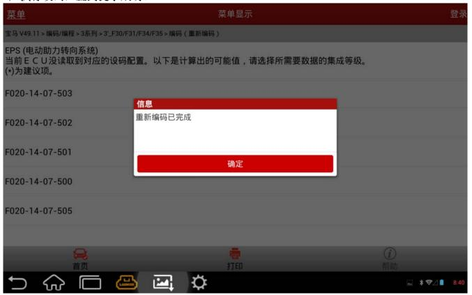
6). 设码完成后,进入自动搜索或手动选择 EPS 系统,读取/清除故障码,看对应设码故障是 否仍然存在。
