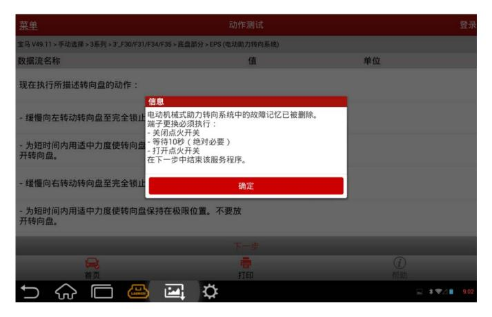
9). 初始化调试完成后,再次读取/清除故障码,看对应设码故障是否仍然存在。若故障码仍存在,则初始化调试未成功,需重新尝试初始化调试。
