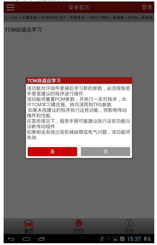
4). 选择"离合器",需要注意的是执行这个功能可能会设置故障码,导致故障灯亮,在功能结束后一定要手动执行清码消除产生的故障码;
