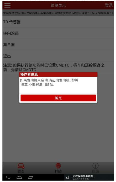
7). 查看确保档位在 P 档,同时保持制动踏板踩住,将油门踏板踩到底并保持使节气门全开, 发动机速度达到最大,以便下一步开始执行离合器初始化调整
