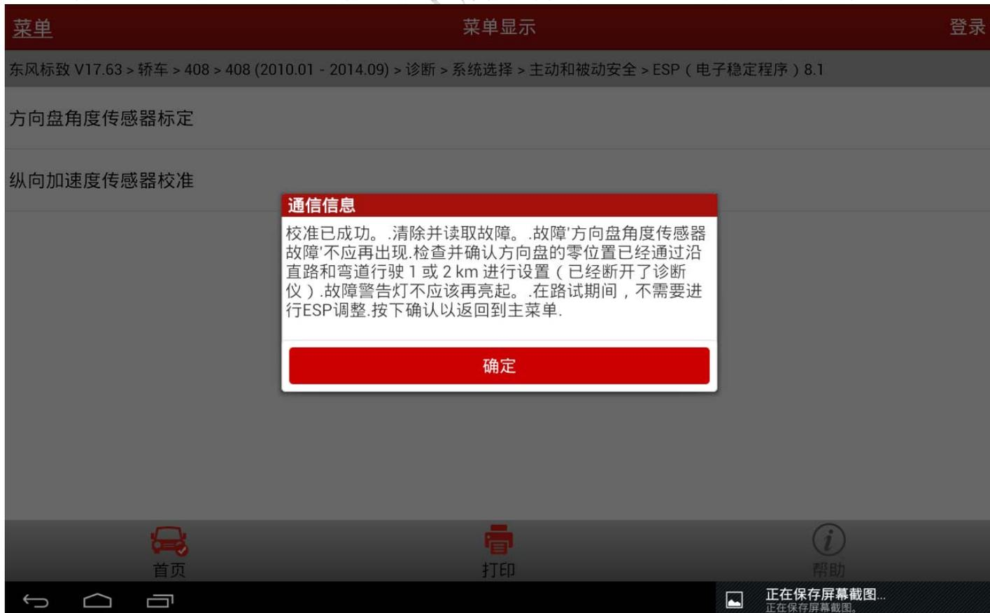
19). 至此转角传感器标定功能已经做完，这时需“确定”返回，进行读取故障码，清除故障码的操作，确保无相关故障码后，移除诊断设备，进行路试，以确保标定的成功。
