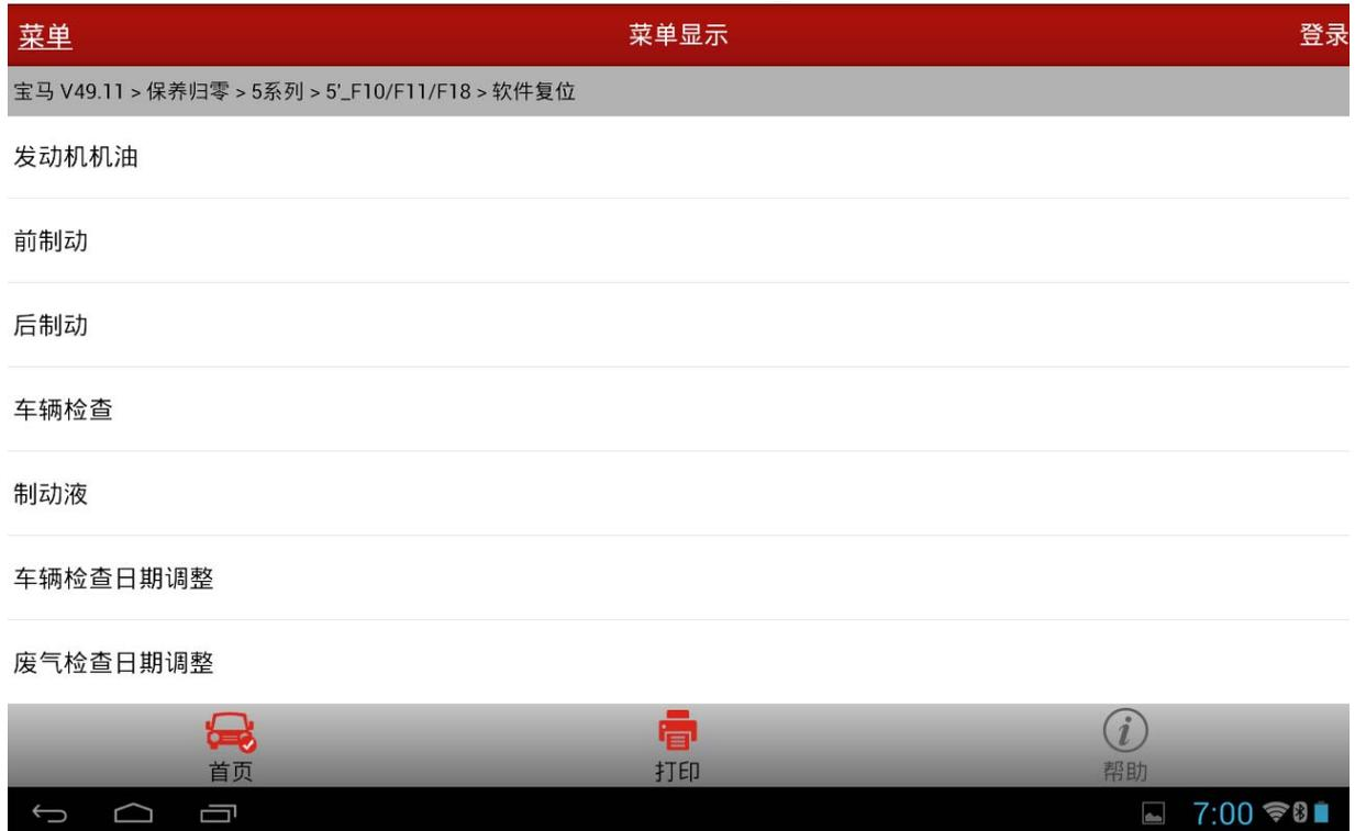
3). 保养功能执行, 此处对发动机机油、车辆检测日期调整进行操作说明, 其他功能类似 A). 发动机机油, 如下图, 点击是开始执行功能
