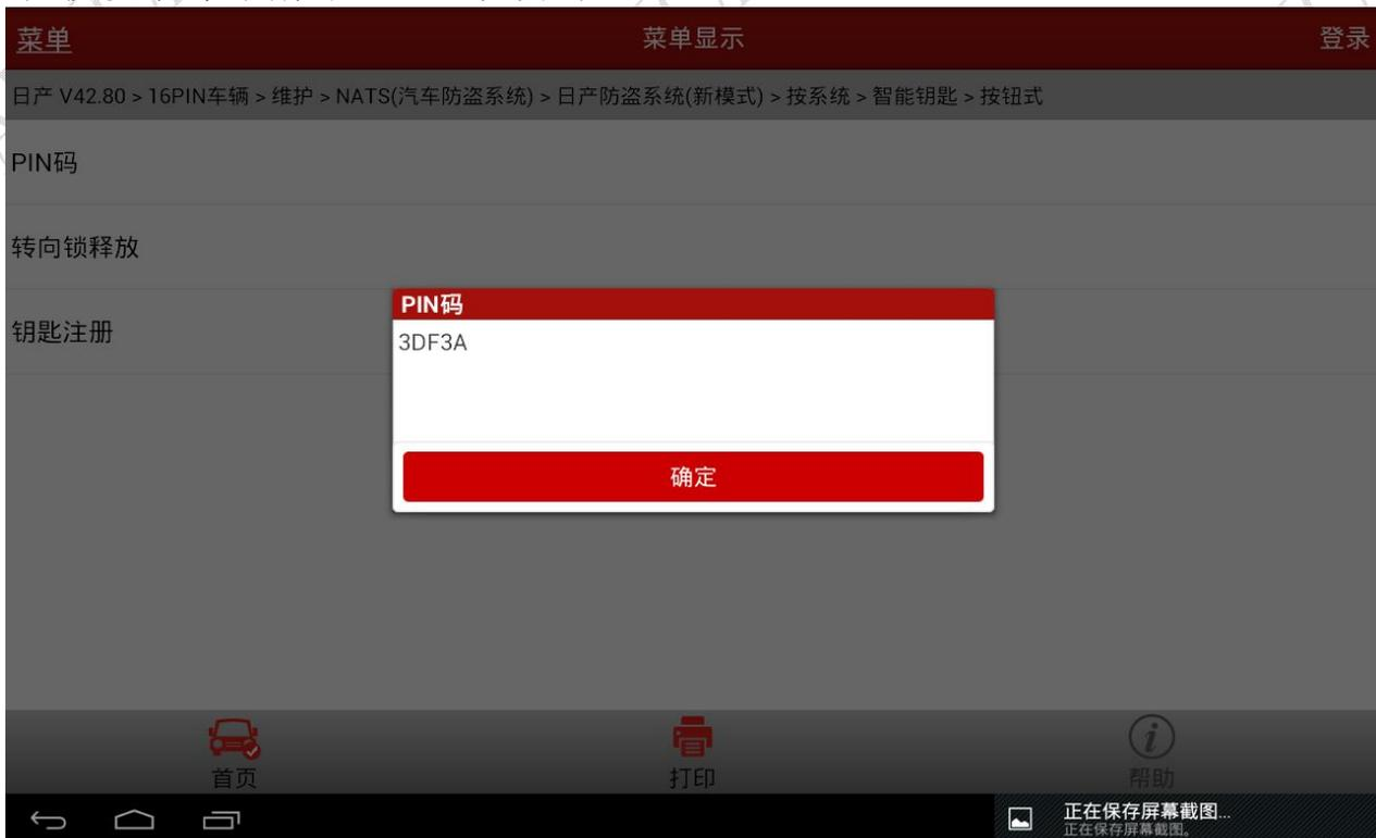
11). 利用 X431PR03 读取到 5 位识别代码后, 需通过自带的 PIN 密码计算器得到随机码。返回选择 PIN 密码计算器, 并输入 3DF3A, 如图 4;
