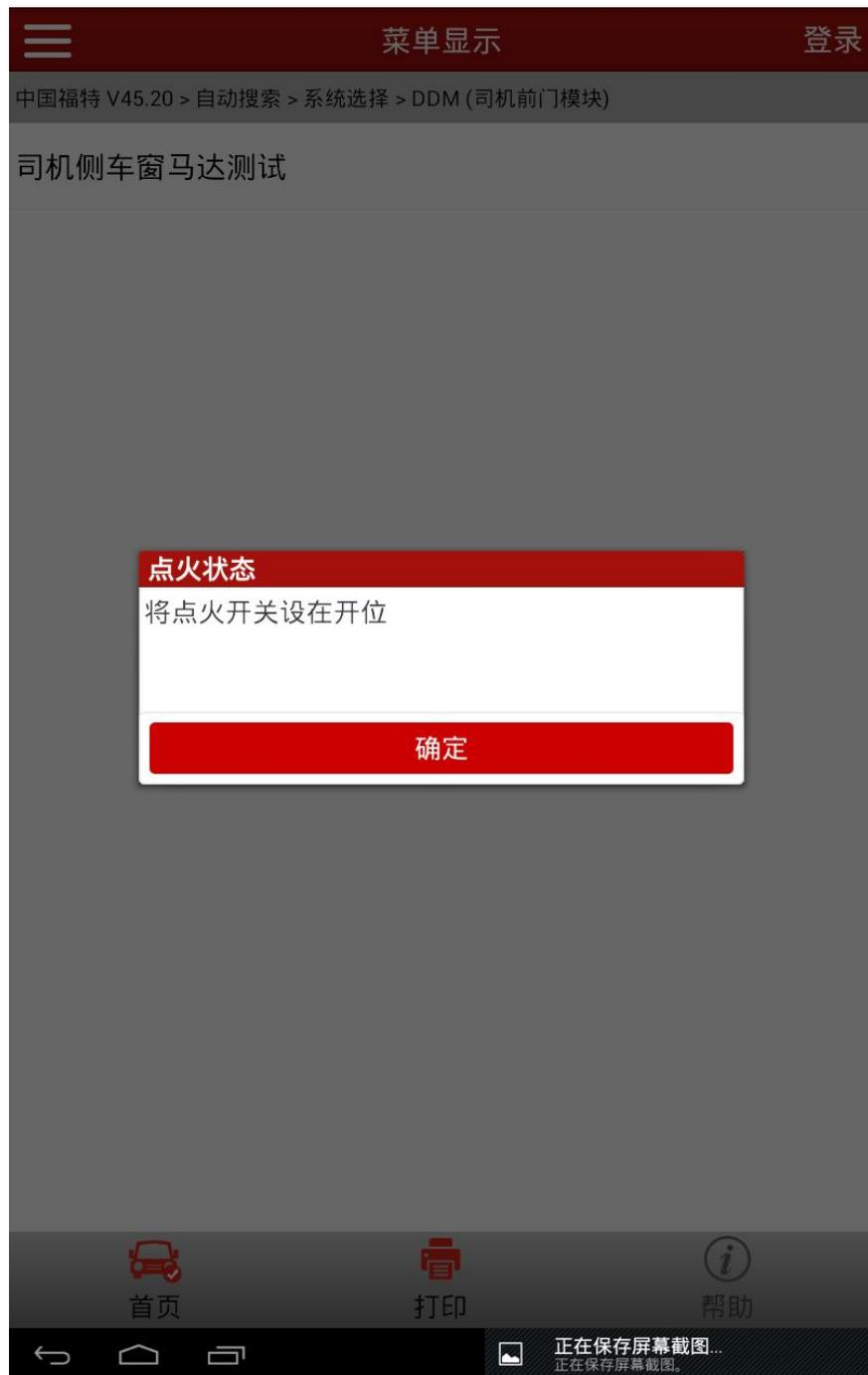
4). 上一步点击确定后，程序引导车窗开始学习并初始化车窗打开和关闭位置
