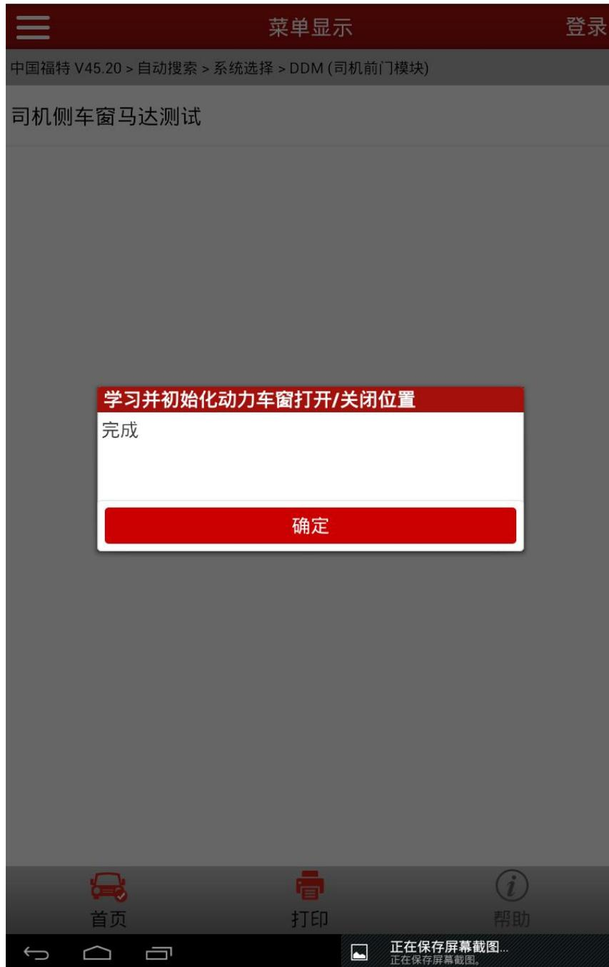
7). 最后提示开关打到 OFF，程序成功执行
