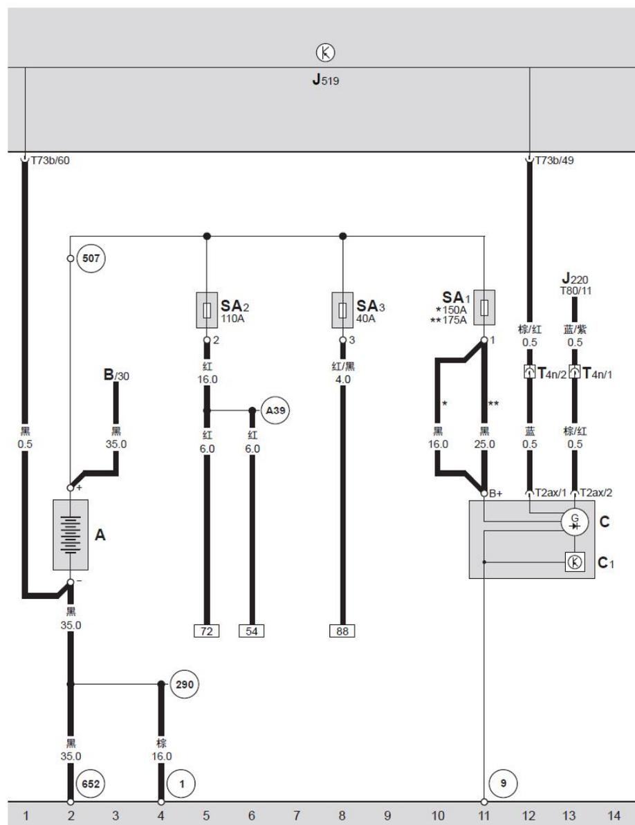
BCM 车身控制器、蓄电池、交流发电机、电压调节器
