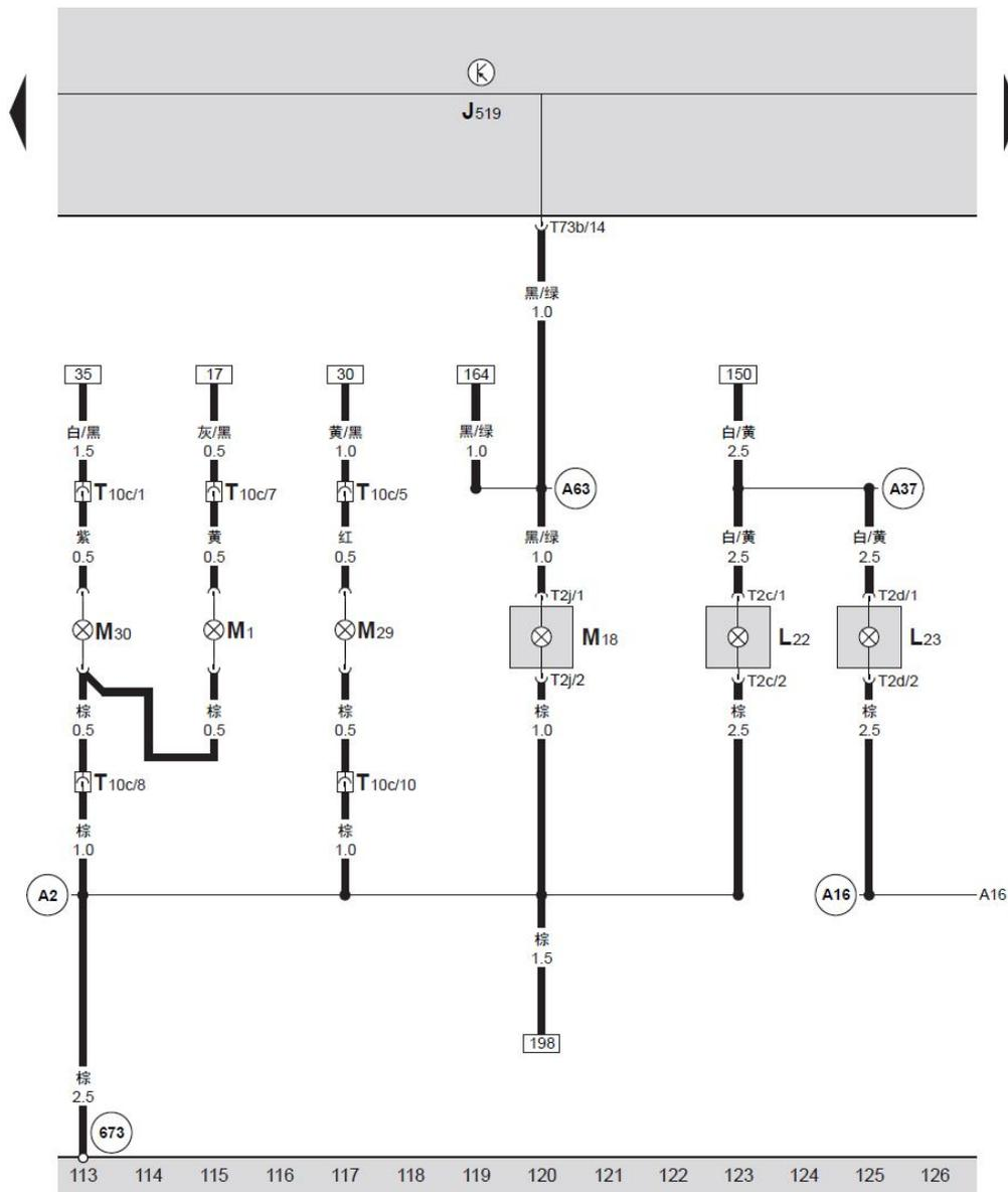
BCM 车身控制器、前雾灯灯泡、左侧停车灯灯泡、左侧侧面转向信号灯灯泡、左侧近光灯灯泡、左侧远光灯灯泡
