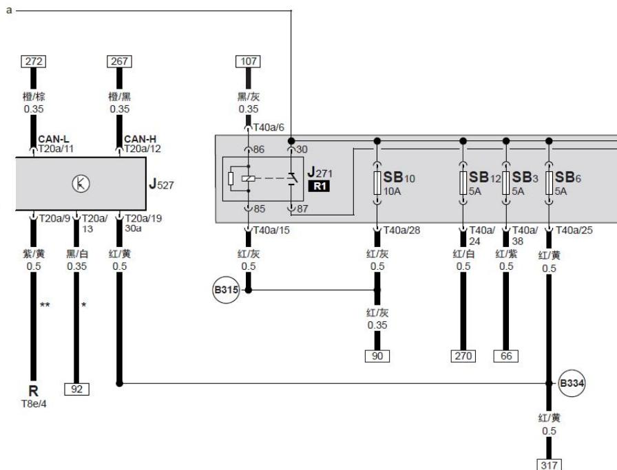
转向柱电子装置控制单元、Motronic 供电继电器
