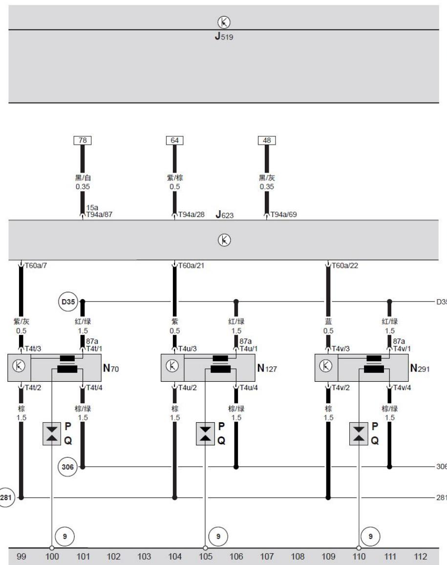
发动机控制单元、带功率输出级的点火线圈、
