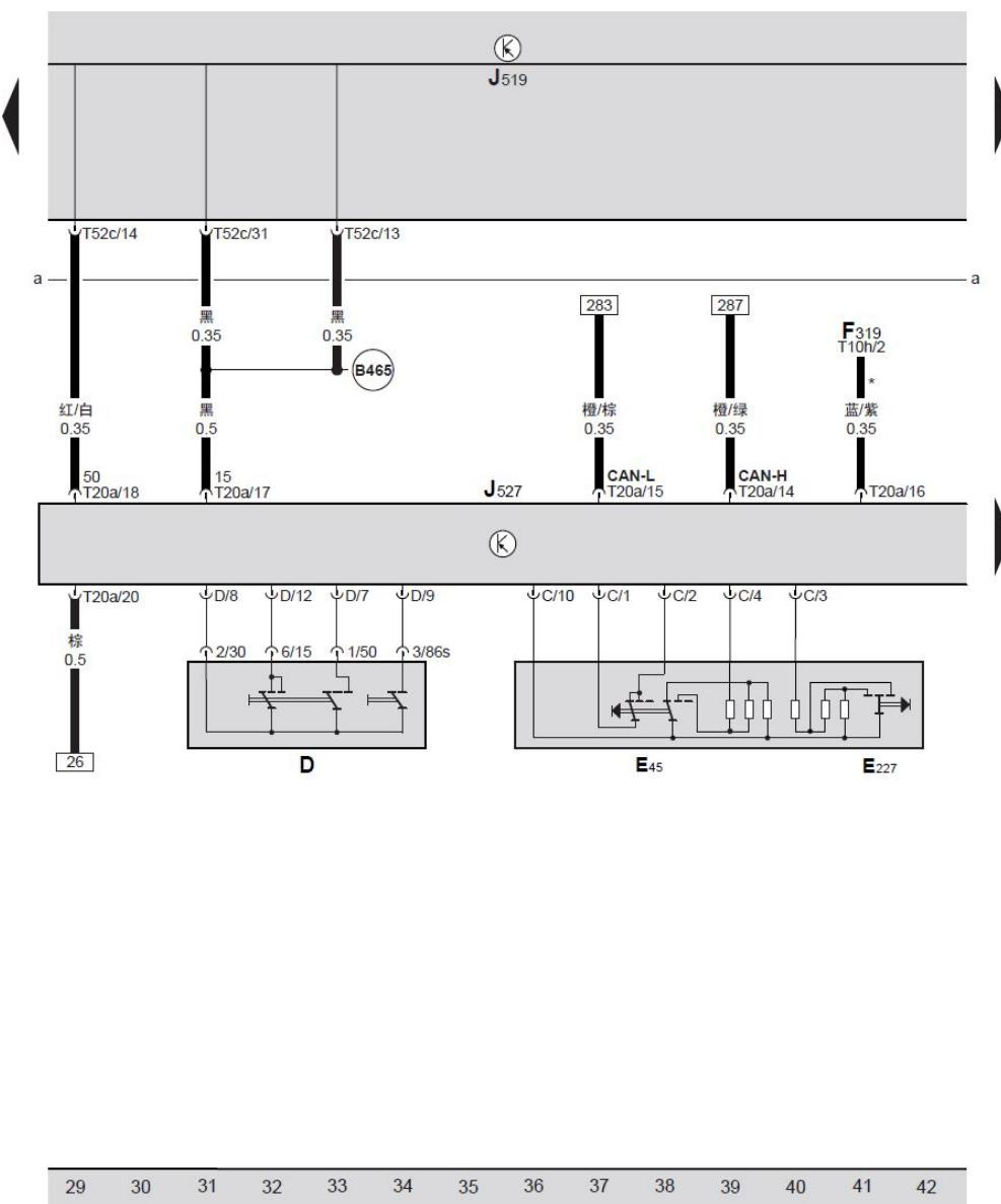
BCM 车身控制单元、转向柱电子装置控制单元、点火起动开关、GRA 开关、GRA 按钮
