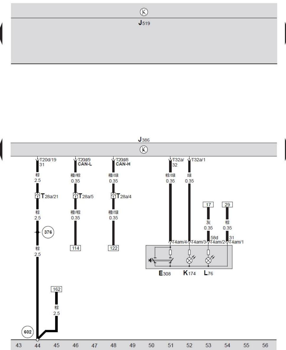
驾驶员侧车门控制单元、驾驶员侧车内联锁按钮、按钮照明、驾驶员侧车内联锁指示灯
