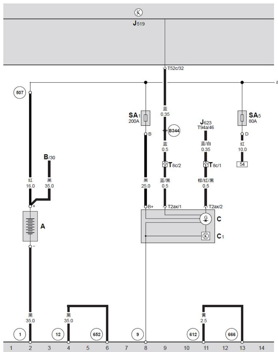
BCM 车身控制单元、蓄电池、交流发电机、电压调节器
