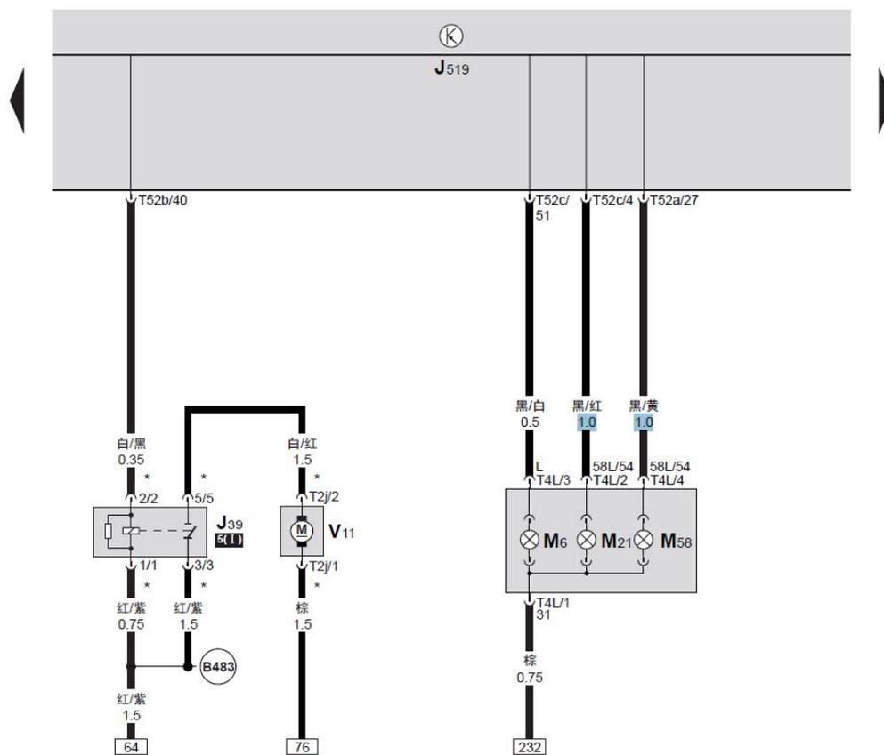
BCM 车身控制单元、大灯清洗装置继电器、左后转向信号灯灯泡、左侧刹车灯和尾灯灯泡、左侧刹车灯和尾灯 2 灯泡、大灯清洗泵
