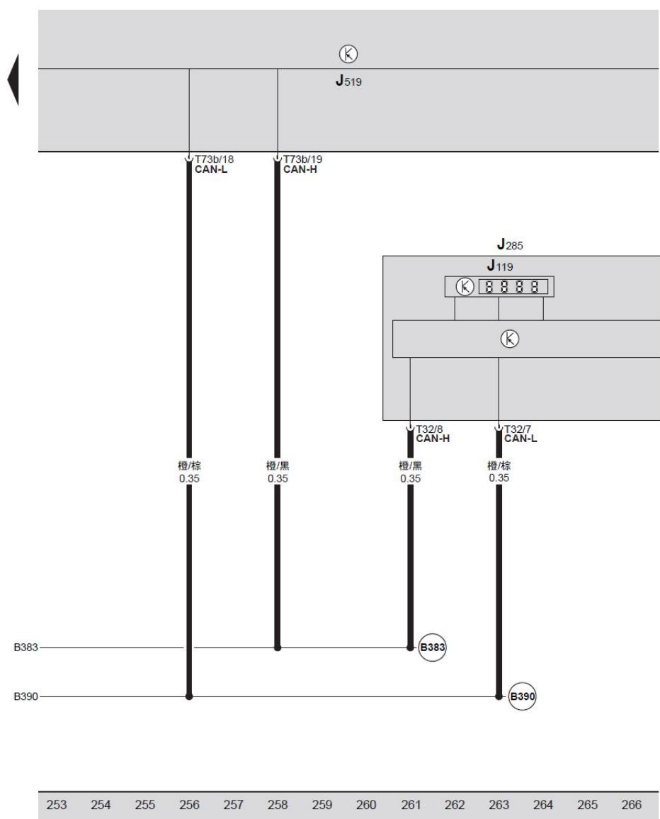
BCM 车身控制器、组合仪表中带显示单元的控制单元、多功能显示器
