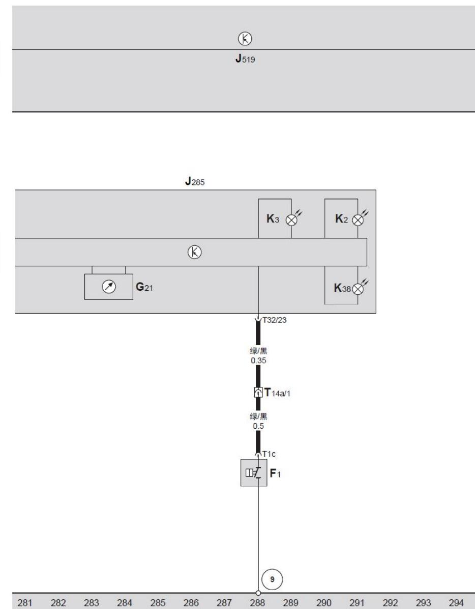
组合仪表中带显示单元的控制单元、车速表、发电机指示灯、油位指示灯、油压开关、油压指示灯
