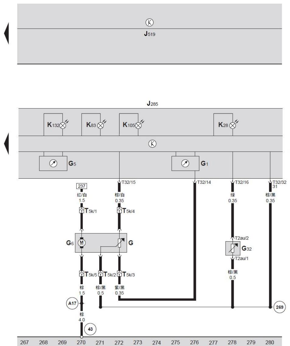
组合仪表中带显示单元的控制单元、燃油储备显示、转速表、排气警示灯、电控节气门故障信号灯、冷却液不足显示传感器、冷却液温度 / 冷却液不足显示指示灯、燃油存量传感器、燃油泵 (供油泵)、燃油存量指示灯
