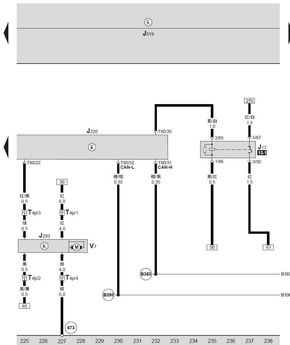
Motronic 发动机控制单元、燃油泵继电器、
