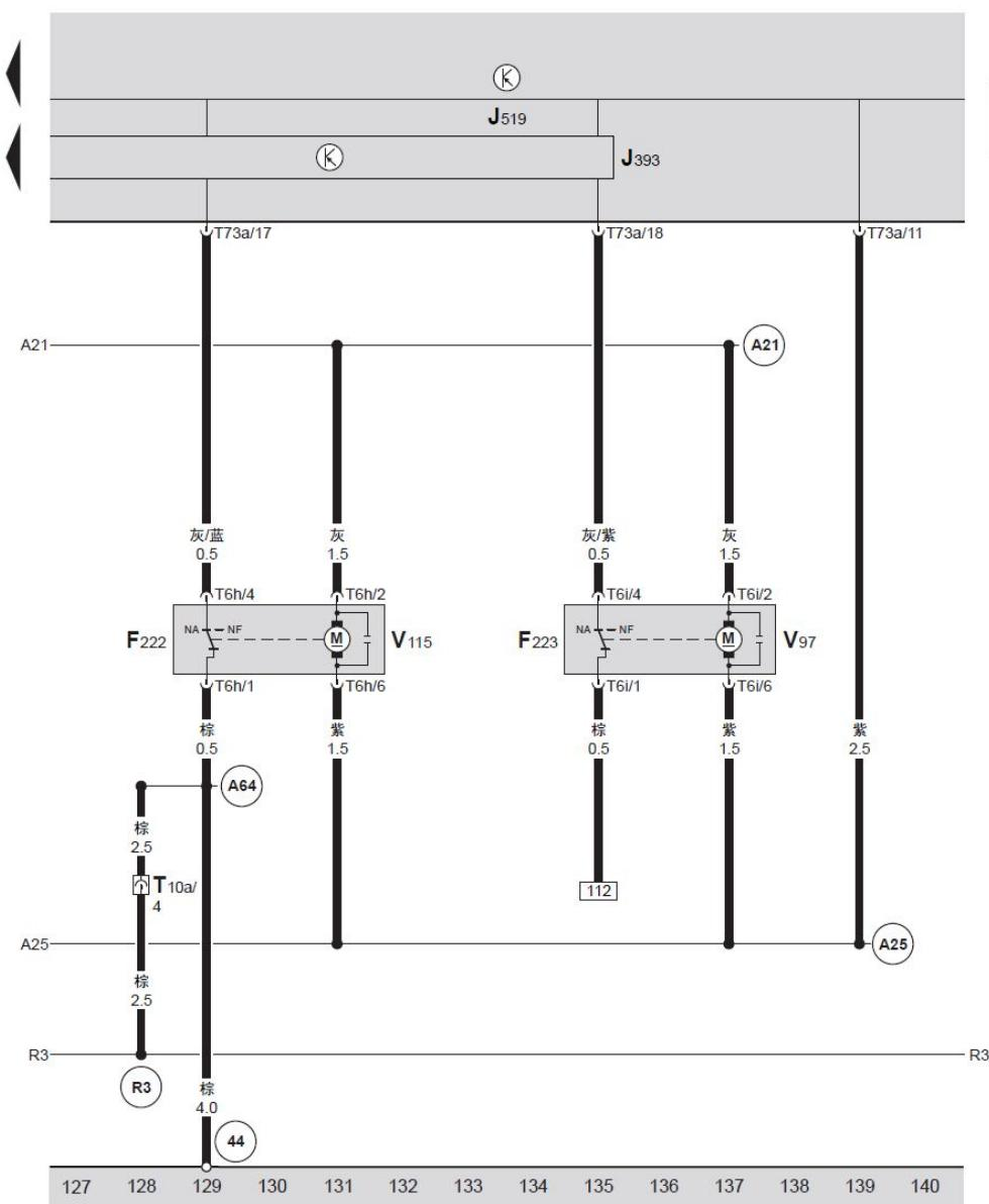
BCM 车身控制器、舒适 / 便利功能系统中央控制单元、中央门锁闭锁单元、车门中央门锁马达
