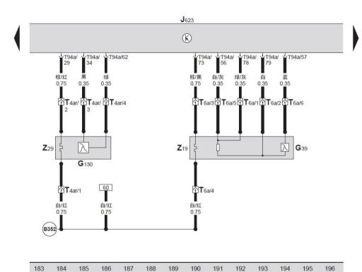
发动机控制单元、氧传感器、氧传感器加热装置、氧传感器 1 加热装置
