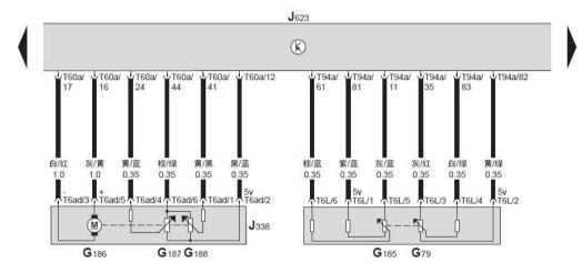
发动机控制单元、节气门控制单元、油门踏板位置传感器、节气门驱动装置(电控节气门)、 节气门驱动装置(电控节气门)角度传感器
