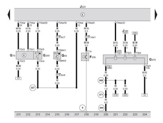
发动机控制单元、机油压力防降开关、空气质量计、水箱出口冷却液温度传感器、进气温度传感器 2、离合器位置传感器
