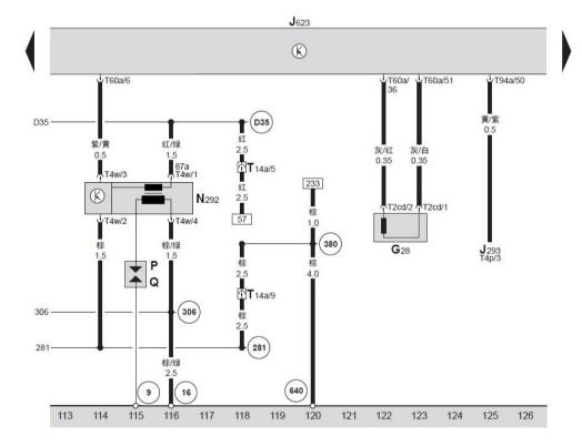
发动机控制单元、发动机转速传感器、带功率 输出级的点火线圈 4、火花塞、火花塞插头
