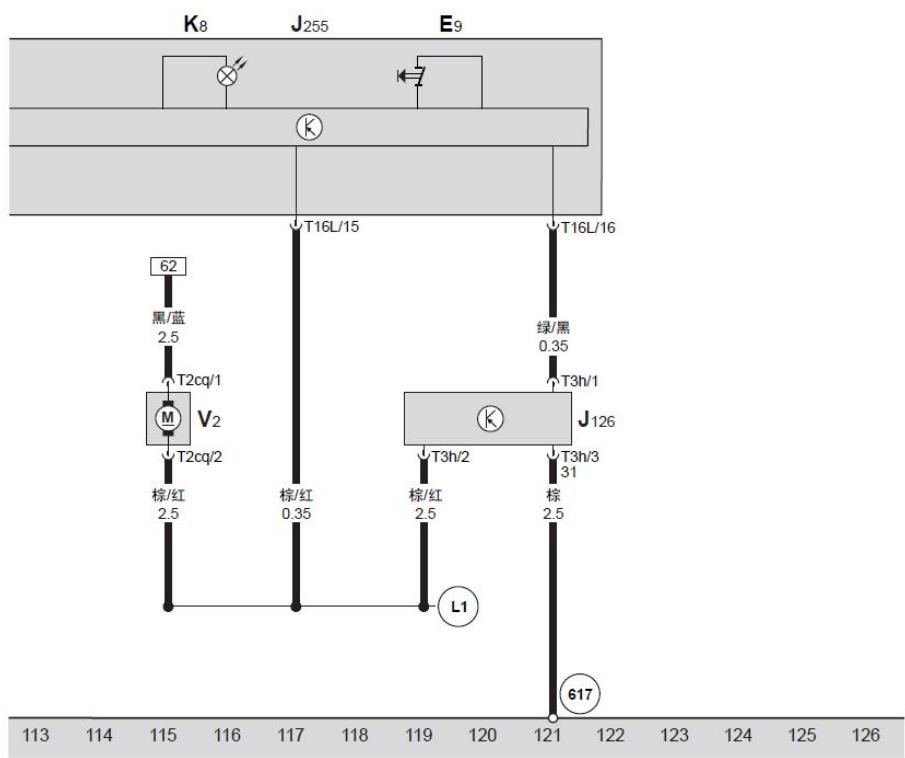
Climatronic 控制单元、新鲜空气鼓风机控制单元、新鲜空气鼓风机开关、新鲜空气鼓风机、新鲜空气鼓风机指示灯
