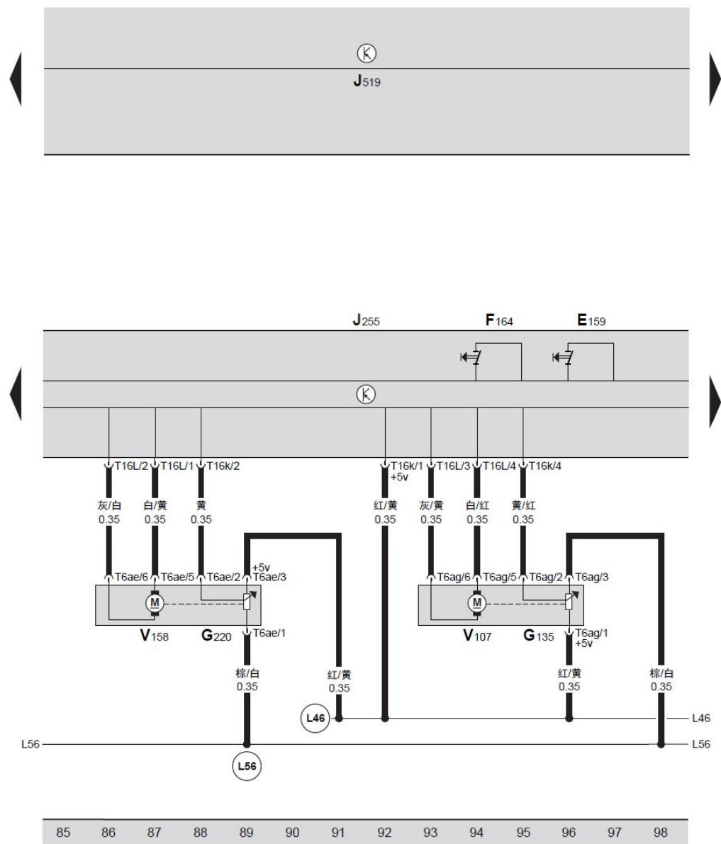
Climatronic 控制单元、新鲜空气和空气内循环风门开关、除霜风门伺服马达内的电位计、左侧温度风门伺服马达的电位计、除霜风门伺服马达、左侧温度风门伺服马达、除霜运行开关
