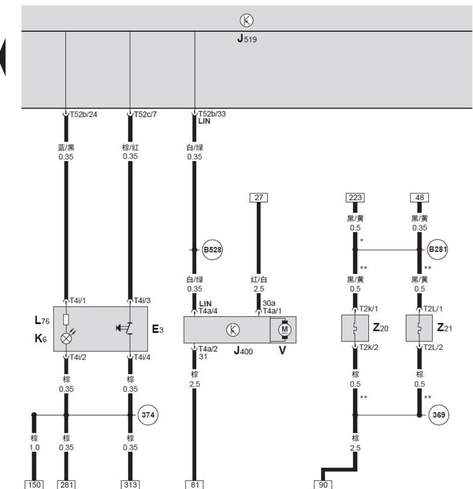
BCM 车身控制单元、刮水器马达控制单元、闪烁报警灯开关、闪烁报警装置指示灯、按钮照明、车窗玻璃刮水器马达、喷嘴加热电阻
