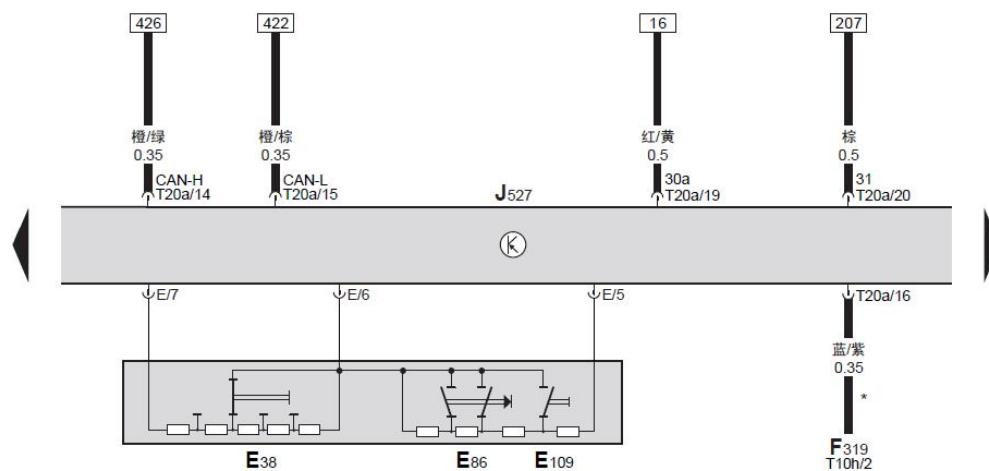
E38 — 车窗玻璃刮水器间歇运行调节器，在转向柱上部右侧拨杆上
