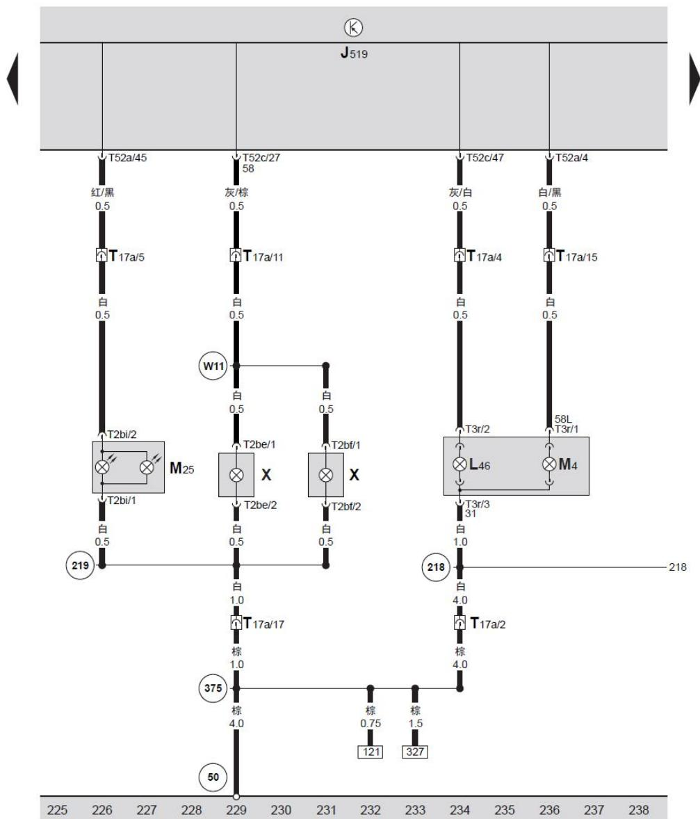
BCM 车身控制单元、左侧后雾灯灯泡、左侧尾灯灯泡、高位刹车灯灯泡、牌照灯
