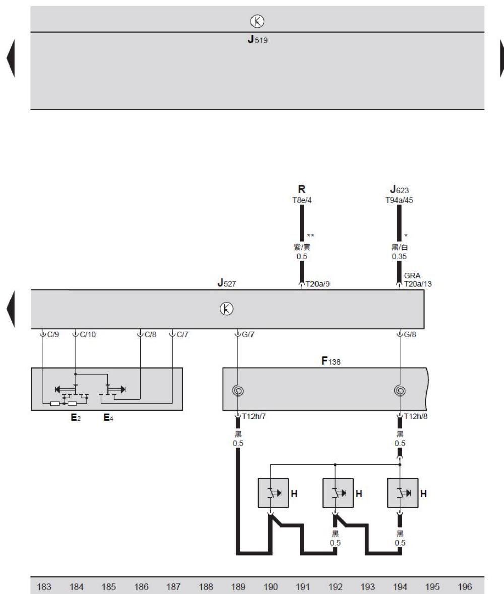
转向柱电子装置控制单元、转向信号灯开关、变光开关、安全气囊螺旋弹簧 / 带滑环的复位环、信号喇叭控制
