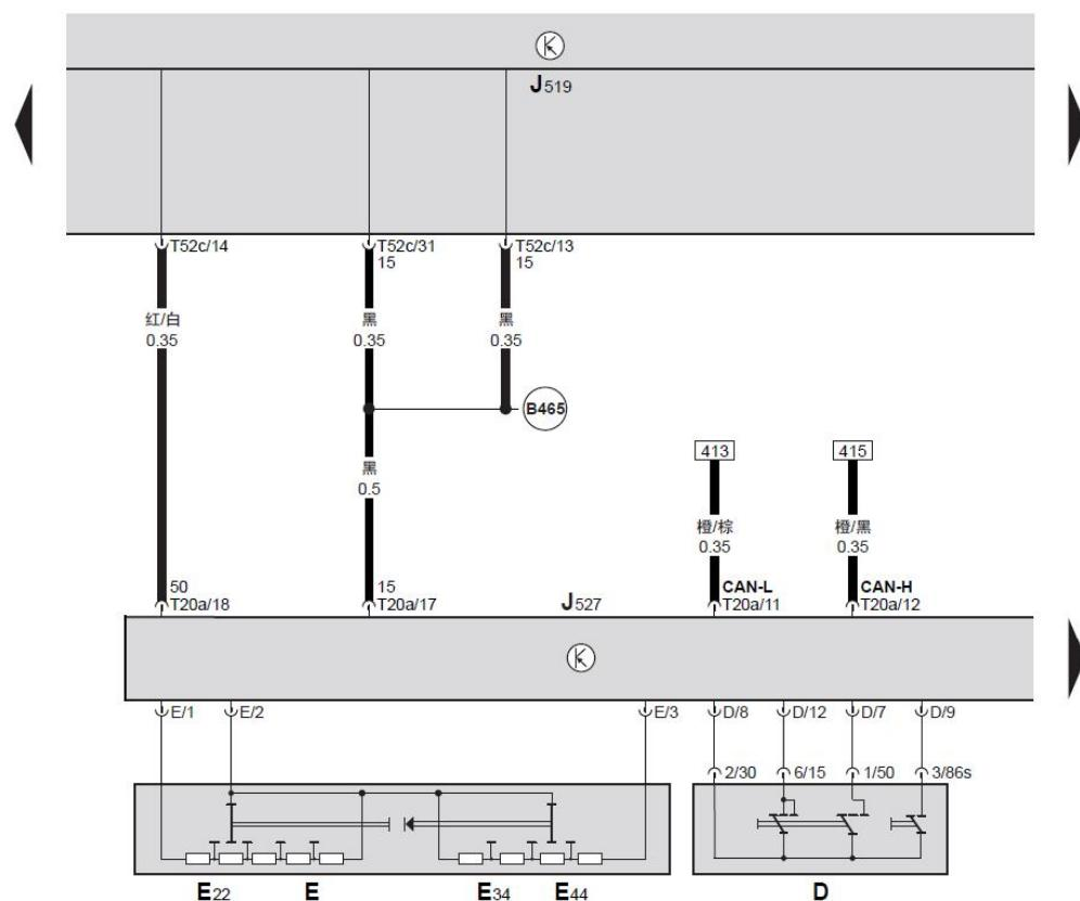
BCM 车身控制单元、转向柱电子装置控制单元、车窗玻璃刮水器开关、间歇式刮水器运行开关、后窗玻璃刮水器开关、车窗玻璃清洗泵开关(清洗刮水自动装置和大灯清洗装置)、点火起动开关
