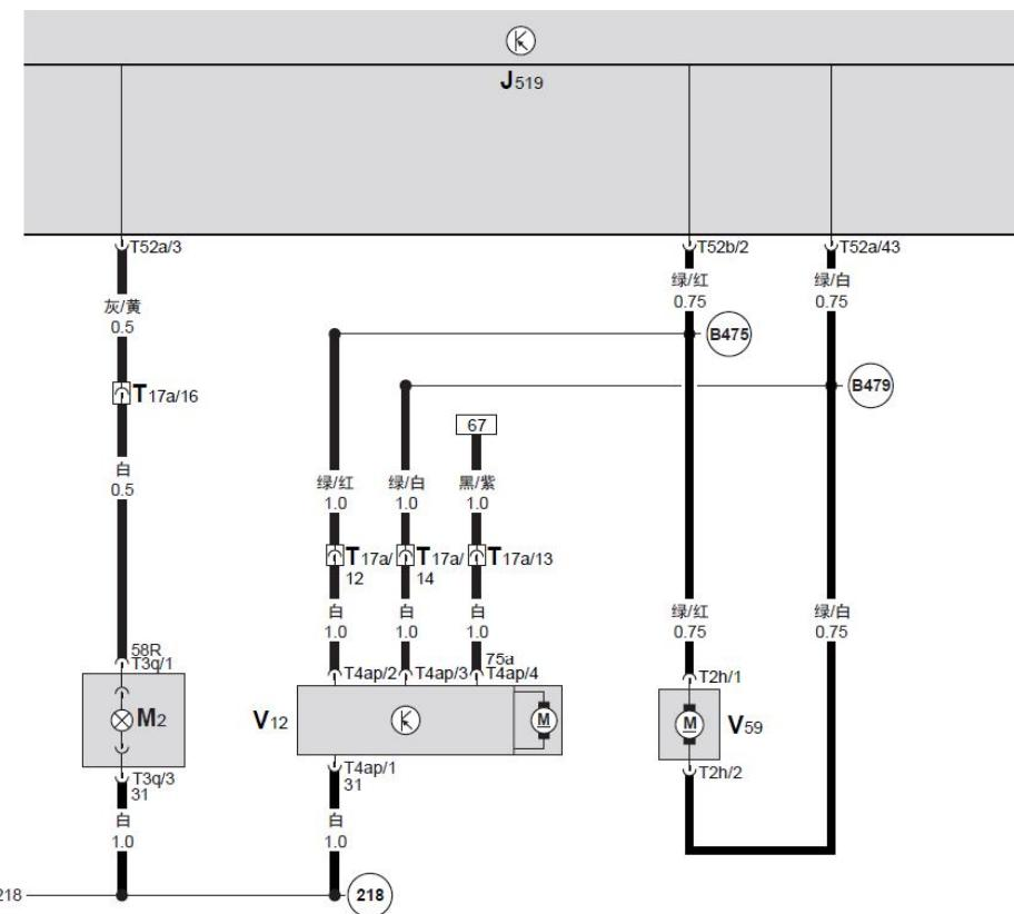
BCM 车身控制单元、右侧尾灯灯泡、后窗玻璃刮水器马达、挡风玻璃和后窗玻璃清洗泵
