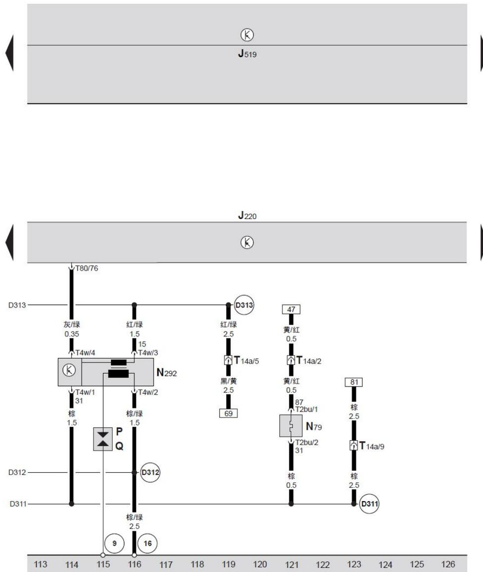
Motronic 发动机控制单元、带功率输出级的点火线圈、火花塞、火花塞插头、加热电阻 (曲轴箱的排气孔)
