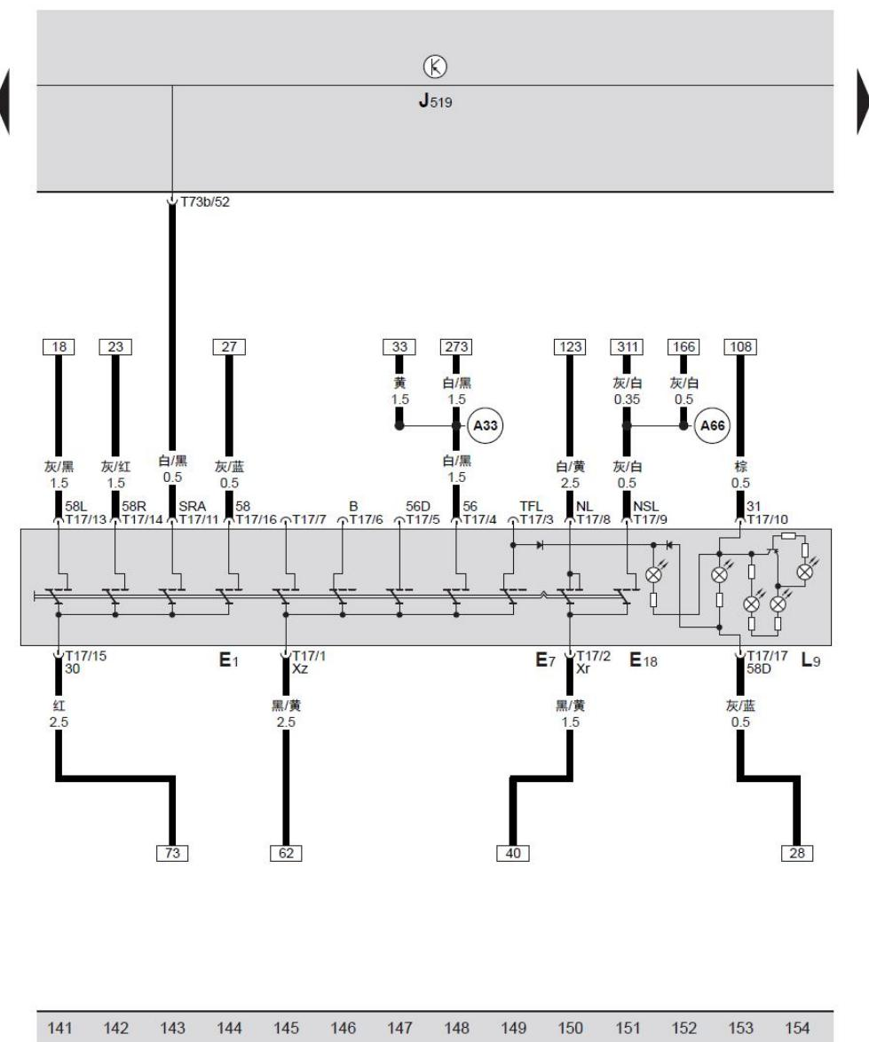
BCM 车身控制器、车灯开关、雾灯开关、车灯开关照明灯泡
