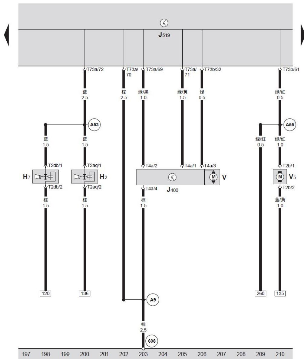
BCM 车身控制器、车窗玻璃清洗泵、刮水器
