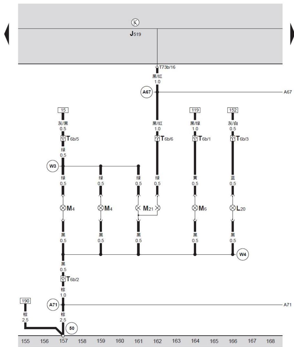
BCM 车身控制器、左侧尾灯灯泡、左后转向信号灯灯泡、左侧刹车灯和尾灯灯泡、后雾灯灯泡
