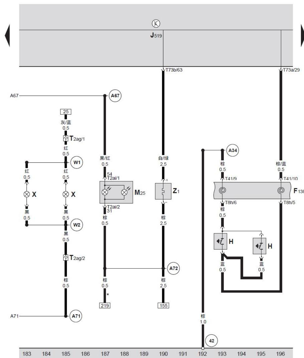
BCM 车身控制器、高位刹车灯灯泡、后行李箱盖中央门锁马达、牌照灯、可加热后窗玻璃、安全气囊螺旋弹簧/带滑环的复位环、信号喇叭控制
