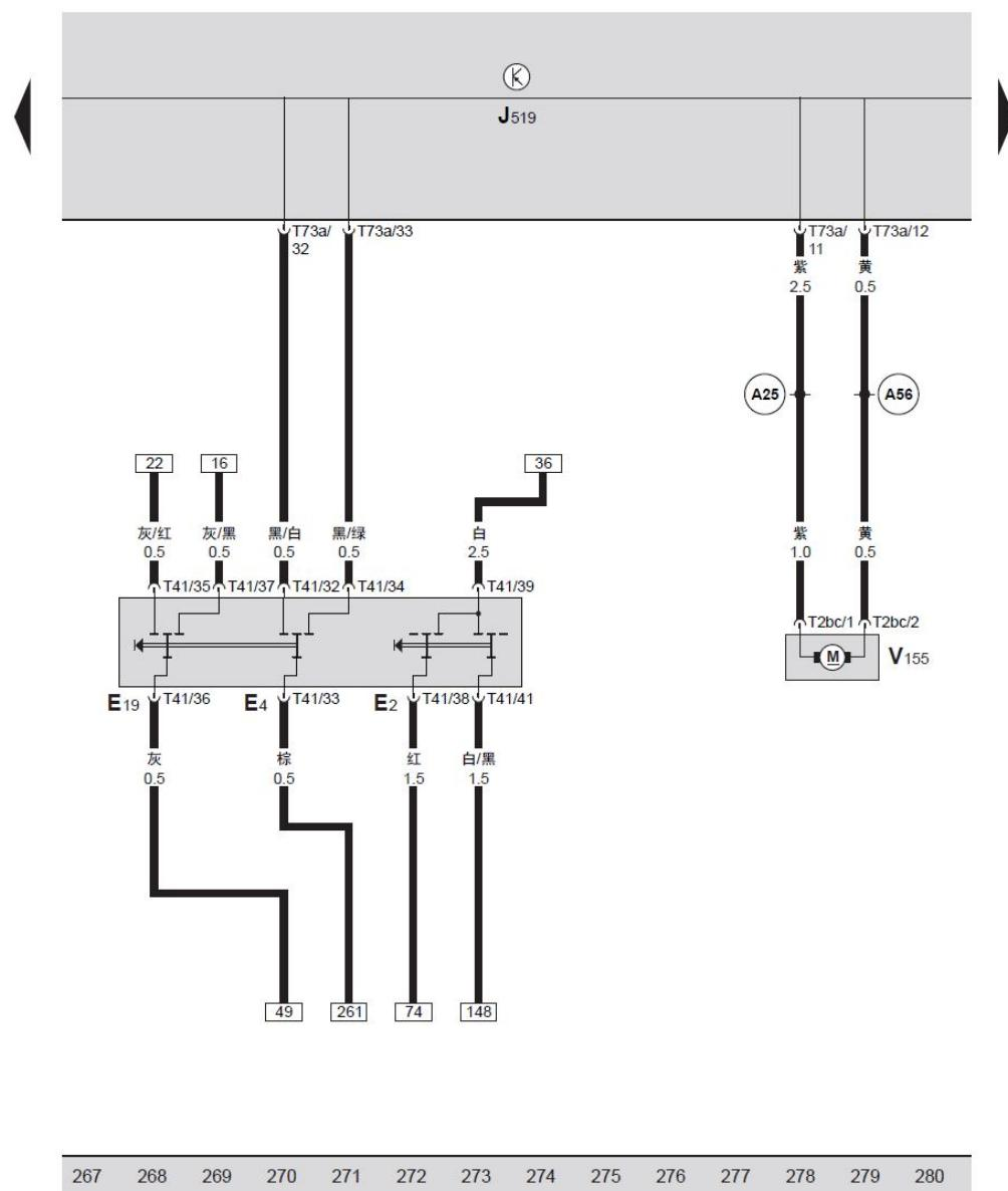
BCM 车身控制器、转向信号灯开关、手动防眩目功能和远光灯瞬时接通功能开关、驻车灯开关、油箱盖板联锁装置马达
