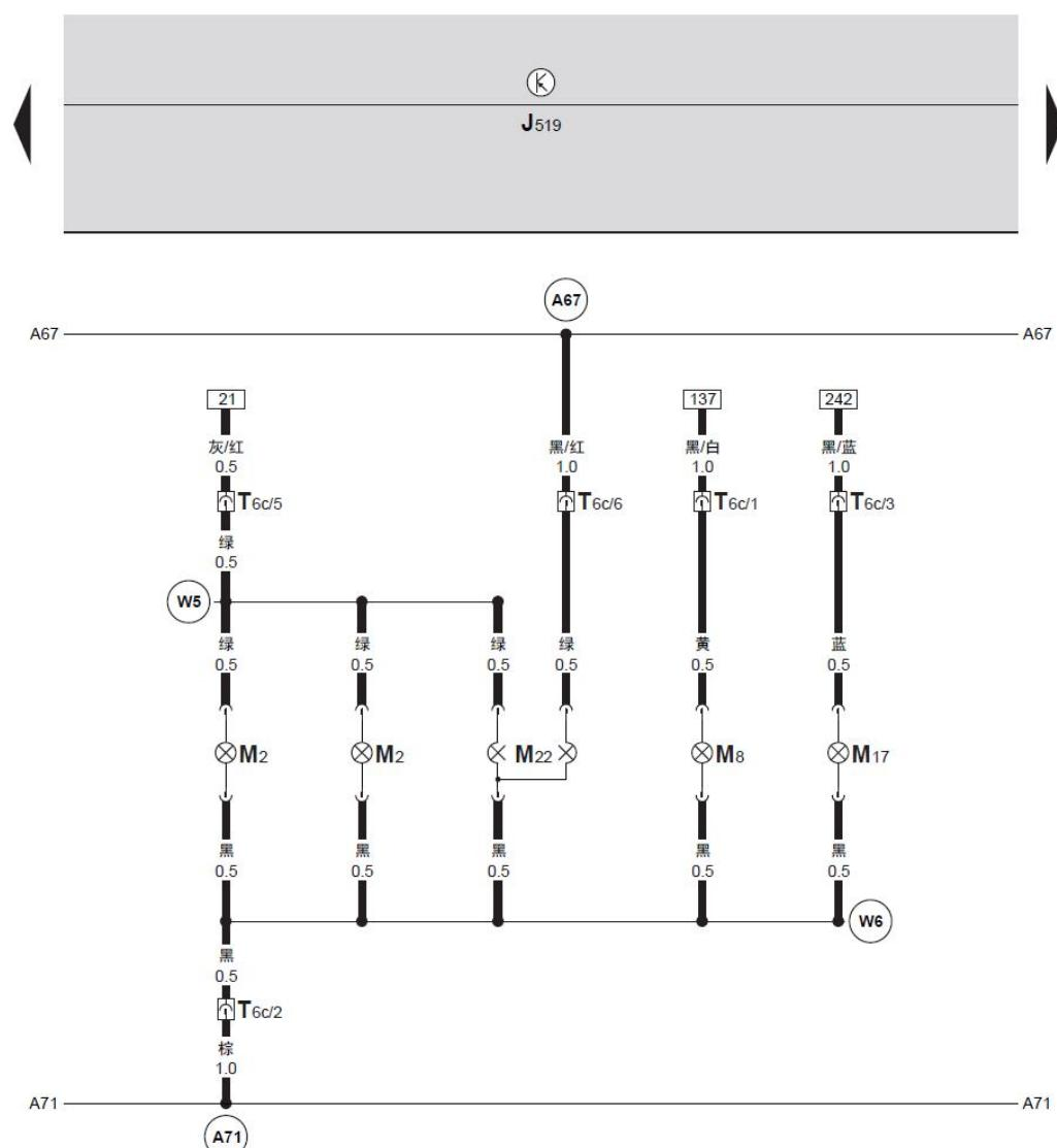
右侧尾灯灯泡、右后转向信号灯灯泡、右侧倒车灯灯泡、右侧刹车灯和尾灯灯泡
