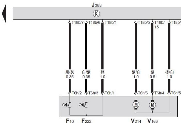
F10 — 左后车门接触开关，在左后车门内
