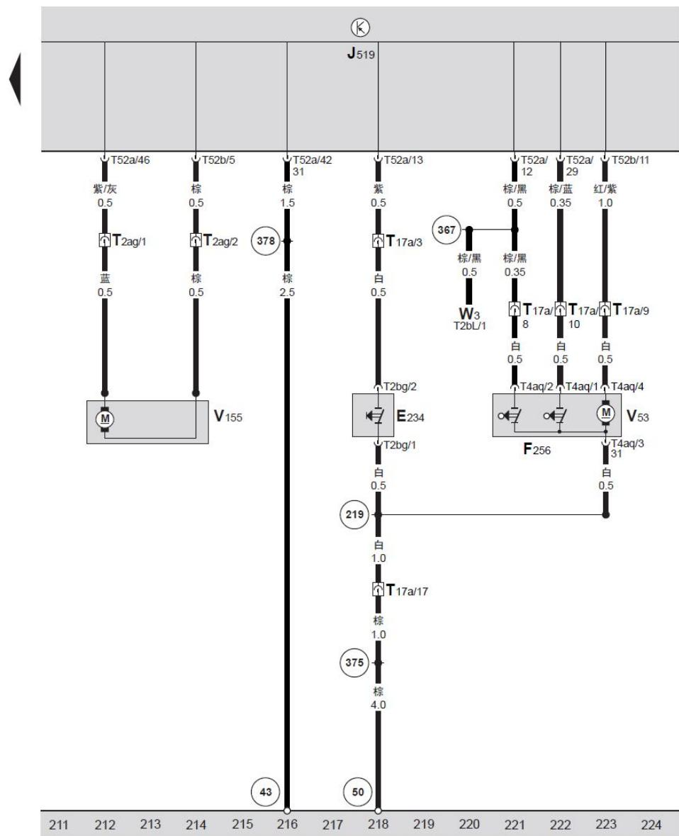
BCM 车身控制单元、后行李箱盖把手开锁按钮、后行李箱盖闭锁单元、后行李箱盖中央门锁马达、油箱盖板联锁装置马达
