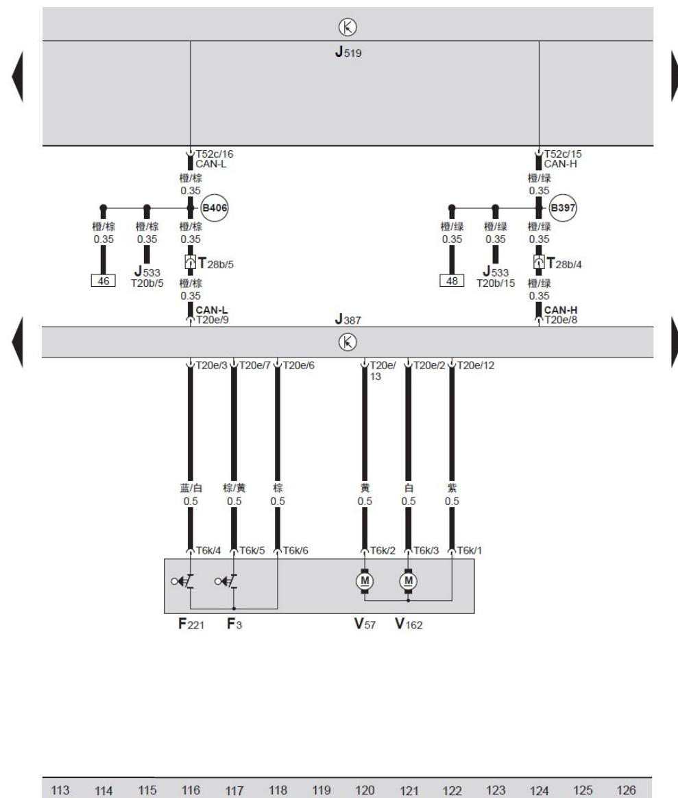
BCM 车身控制单元、前座乘客侧车门控制单元、前座乘客侧车门接触开关、前座乘客侧中央门锁闭锁单元、前座乘客车门中央门锁马达、前座乘客车门中央门锁马达 (Safe )
