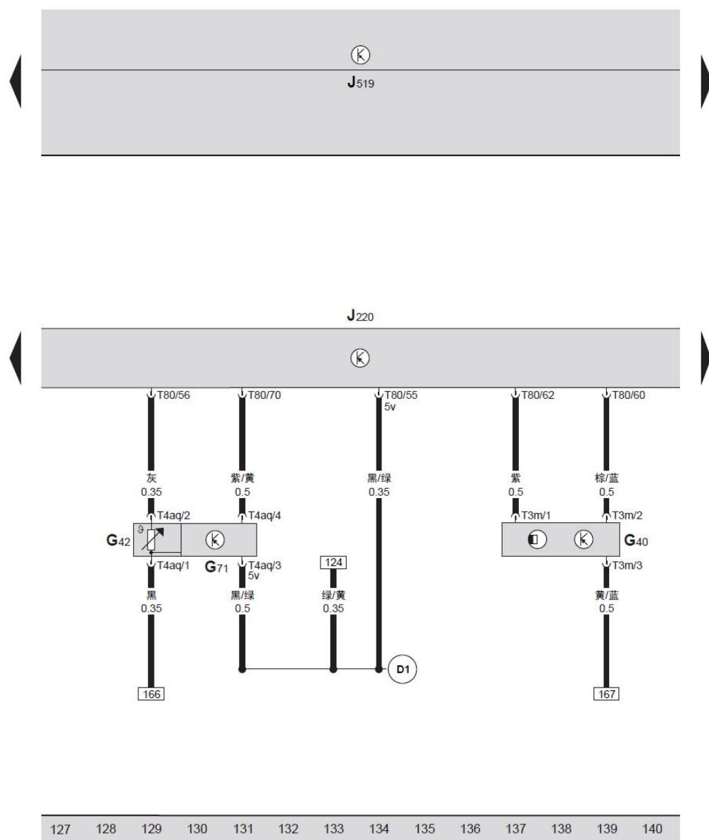
Motronic 发动机控制单元、霍尔传感器、进气压力传感器、进气温度传感器
