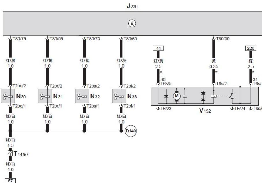
J220 — Motronic 发动机控制单元，在发动机舱内排水槽中间
