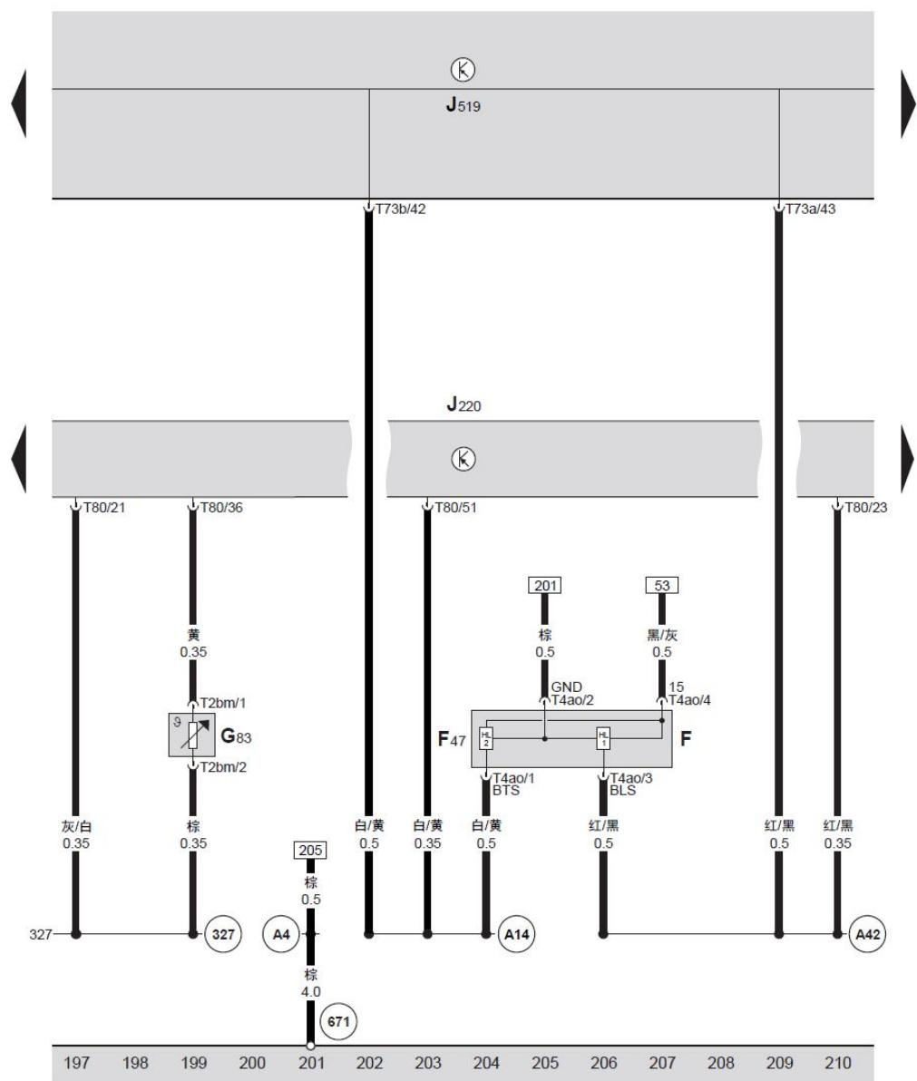
BCM 车身控制器、Motronic 发动机控制单元、制动信号灯开关、制动踏板开关、水箱出口冷却液温度传感器
