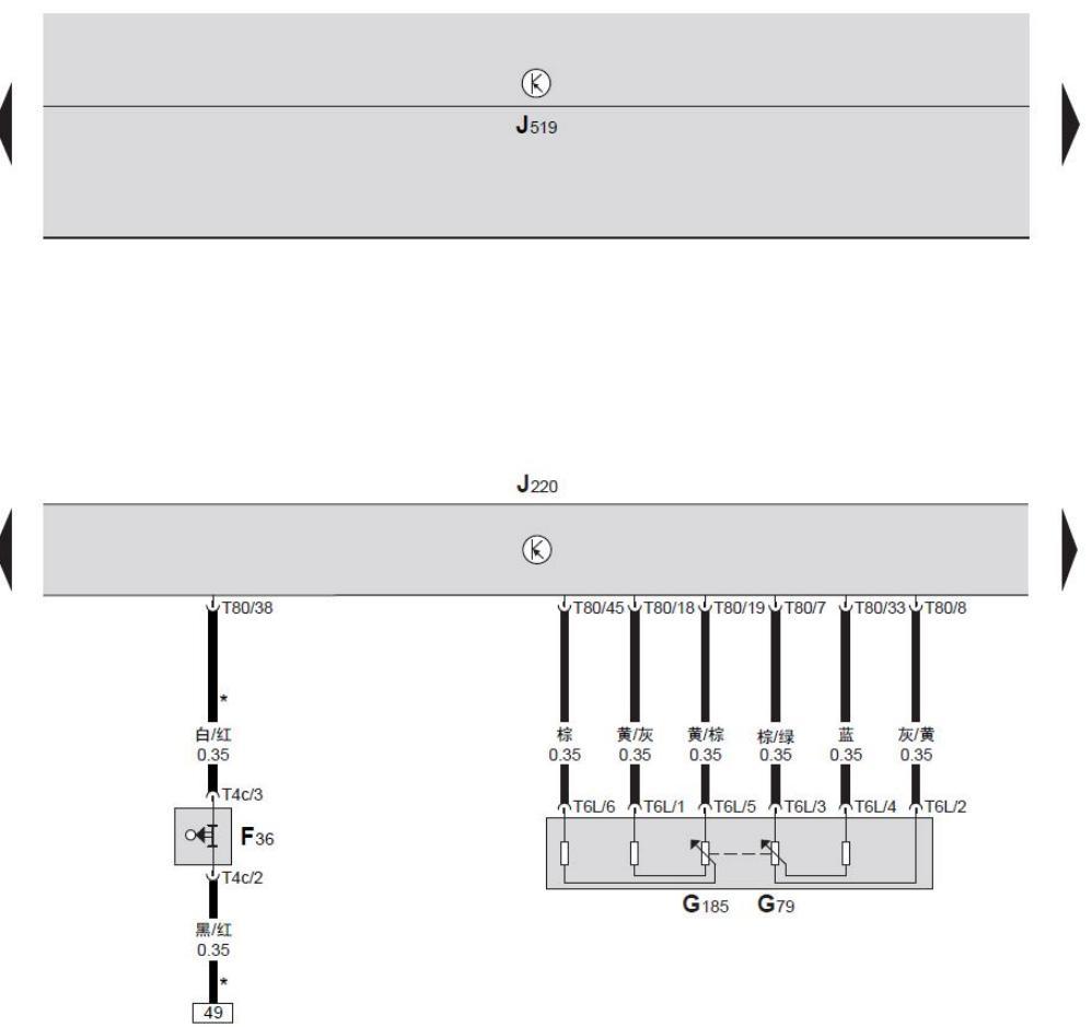
Motronic 发动机控制单元、离合器踏板开关、
