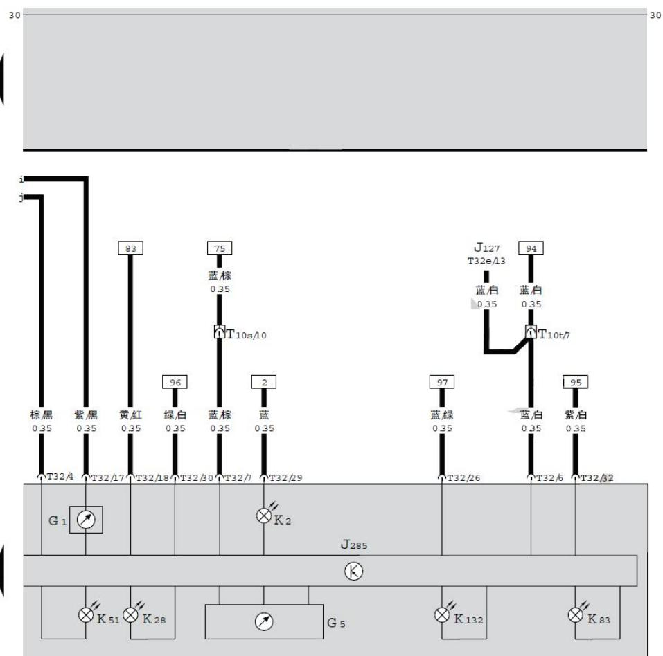
组合仪表控制单元、转速表、充电不足警告灯、燃油表、冷却液不足警告灯、燃油不足警告灯、冷却液温度报警灯、电控节气门故障信号灯 (EPC)、排气警示灯 (EOBD)
